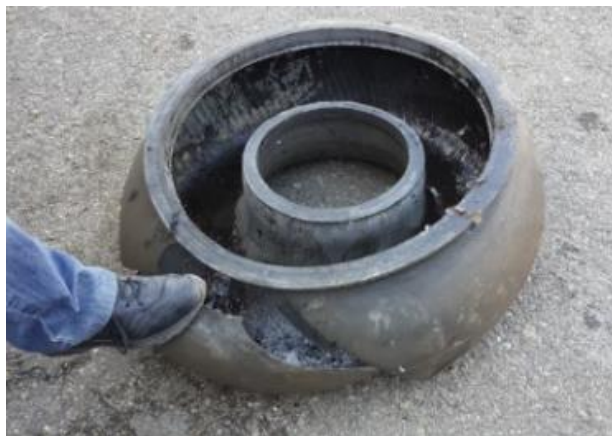
Imaginea nr.12 – exemplu de pernă de aer spartă
