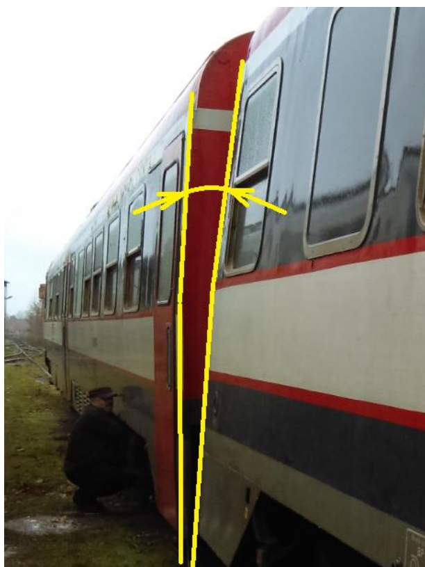
Imaginea nr.10 : Vehiculul se înclină spre perna de aer dezumflată
