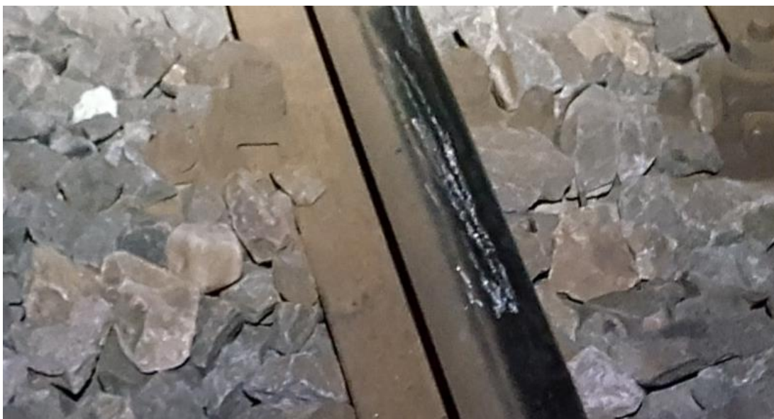
Imaginea nr. 8: Zgârieturi pe șină provenite de la piatra spartă care a patinat sub roți
