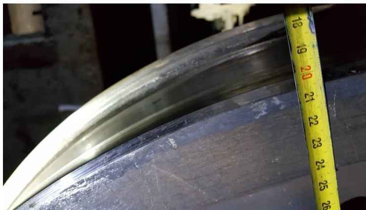
Imaginea nr. 11 - Urme de frecare pe partea exterioră a roții
