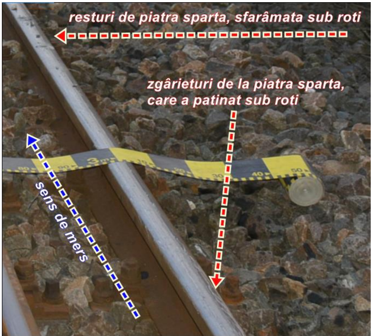
Imaginea nr. 2 – resturi de piatră spartă care a fost sfărâmată de roți zgârieturi făcute de piatră spartă care a patinat sub roți
