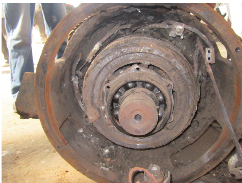
Foto – conductorul de legătură între polul principal și auxiliar secționat
