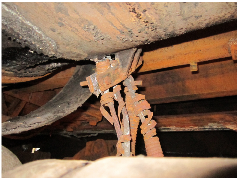
Foto- izolația cablurilor la ieșirea din motorul electric, arsă
