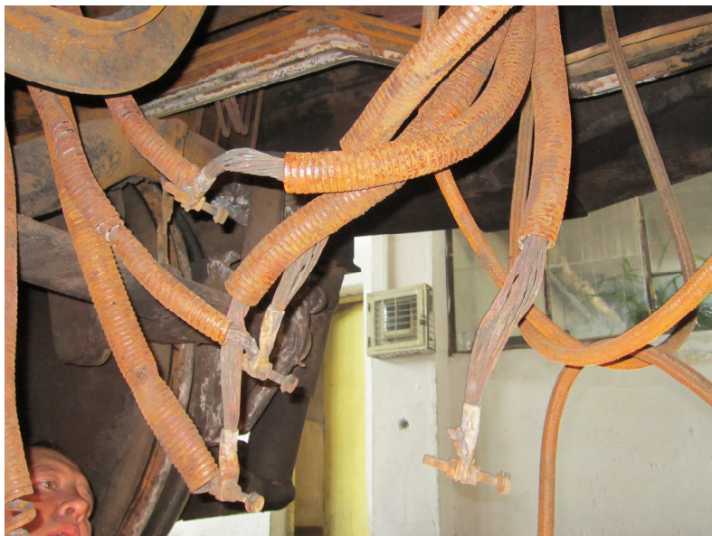
Foto - izolația cablurilor aferente motorului electric arsă, iar placa de borne lipsă în urma arderii
