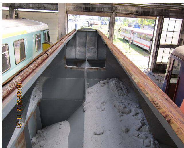
Foto 3: Compartimentul din spate partea dreaptă a sensului de mers rămas nedescărcat la primul boghiu în sensul de mers
