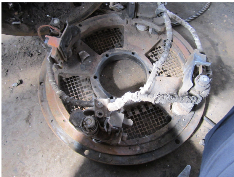
Foto – suport portperie cu legătura flexibilă a periei colectoare secționată și urme de topitură
