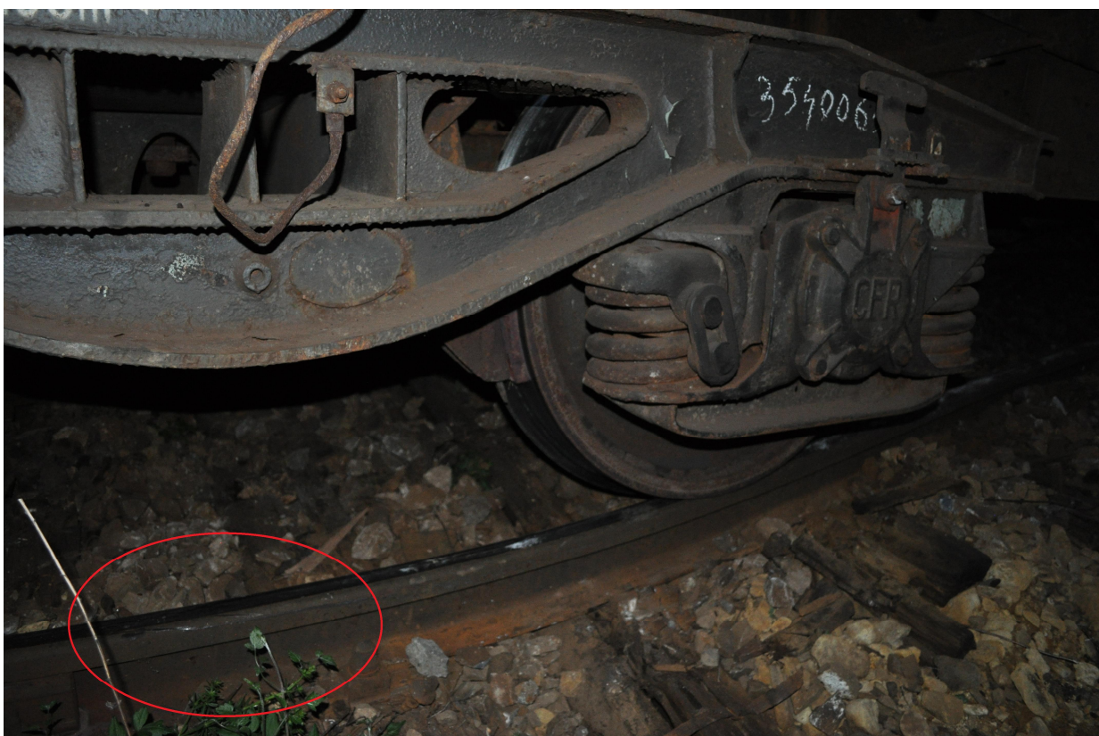
Figura 6 - 2 urme de deraiere pe partea dreaptă
