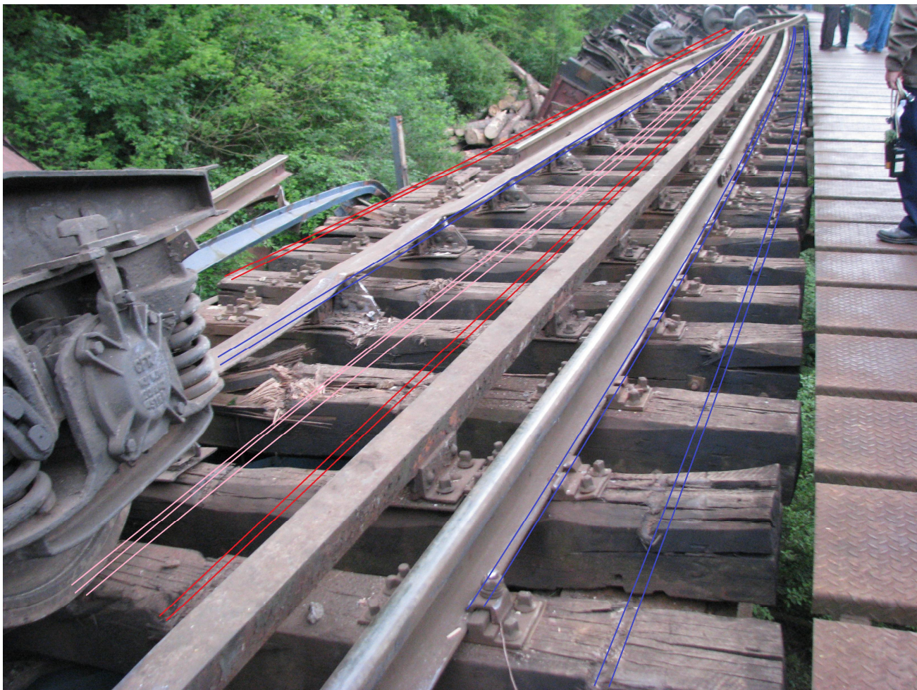
Figura 9 Urmele lăsate pe pod de vagoanele deraiate
