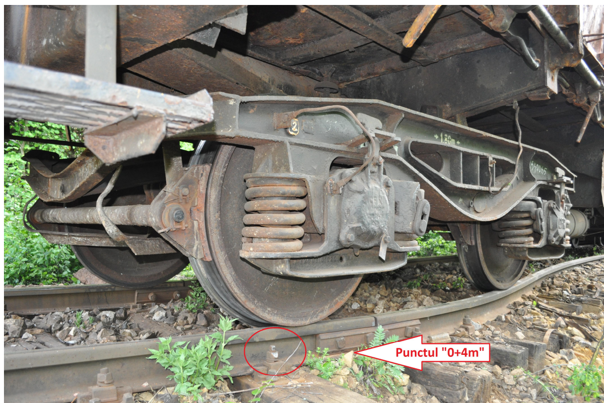
Figura 4 - Urma de deraiere denumită Punctul “0+4m”
