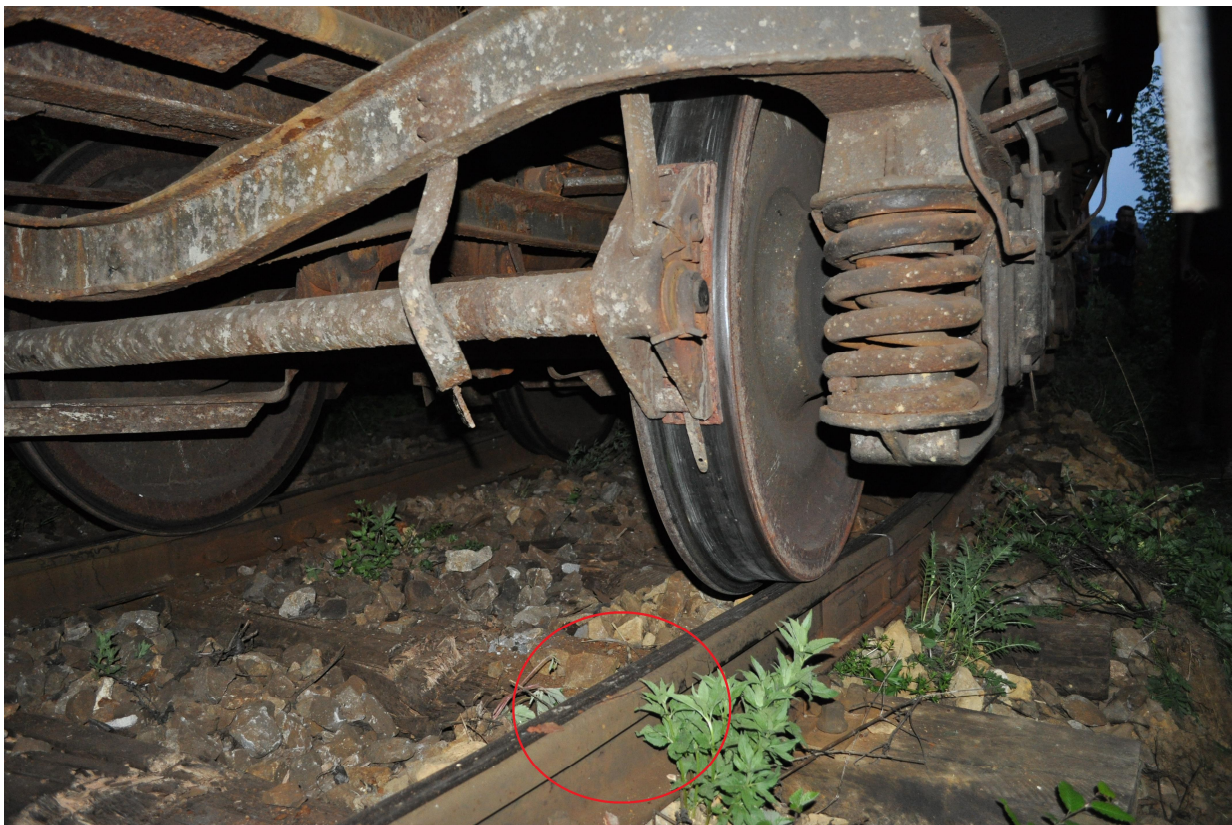
Figura 5 - O urmă de deraiere pe partea dreaptă
