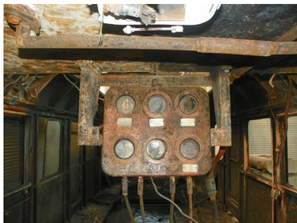
Fig.2 Panou aparate supraveghere a motorului diesel
