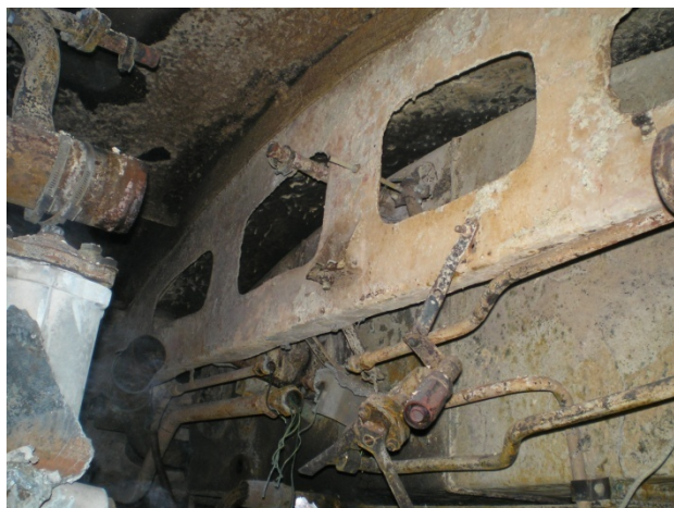
Fig.3 Plafonul cutiei locomotivei în zona producerii incendiului
