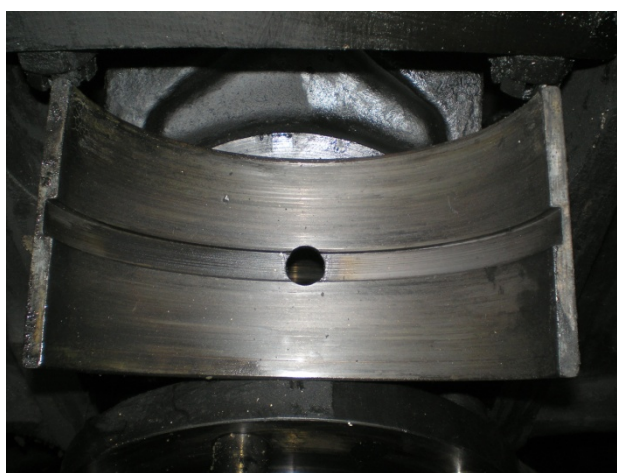
Fig.9 Cuzinet fus palier arbore cotit
