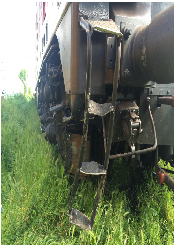
Fig. 6 - Scara de colț deformată
