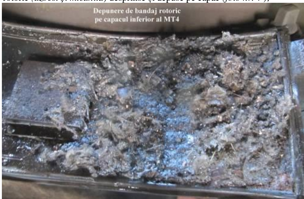
Foto nr.4 – depuneri pe capacul motorului de tracțiune nr.4
