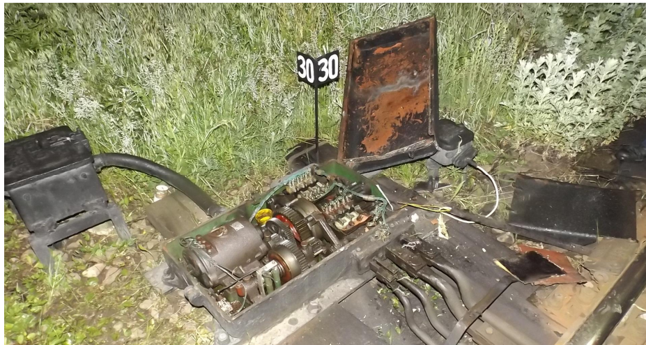
Fig.3 - Vedere de ansamblu a electromecanismului lovit
