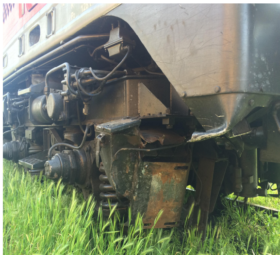
Fig.6 - placa de fixare a carcasi inductorului carcasi inductorului
