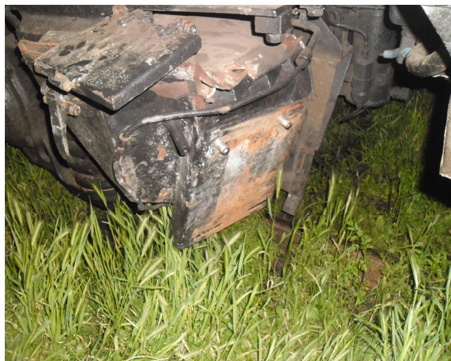
Fig.5 - vedere cu cutia nisipar deformată și placa de susținere a
