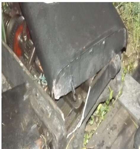
Fig.4 - cutia spartă a electromecanismului
