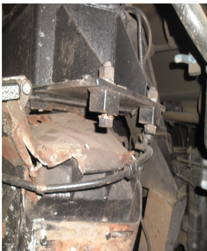
Fig. 7 - prinderea cutiei nisipar după accident
