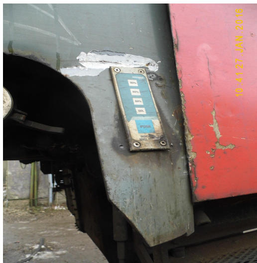
Foto nr.1 Suport mecanism ușă deformat
