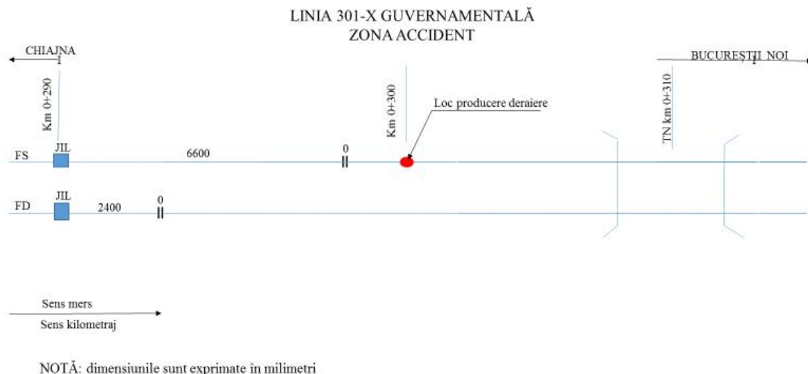
Fig. 9 – schița cu poziția joantelor în zona accidentului
