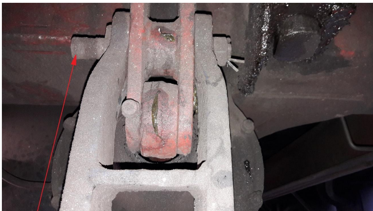
bulon acționare pârghie mecanism comandă
