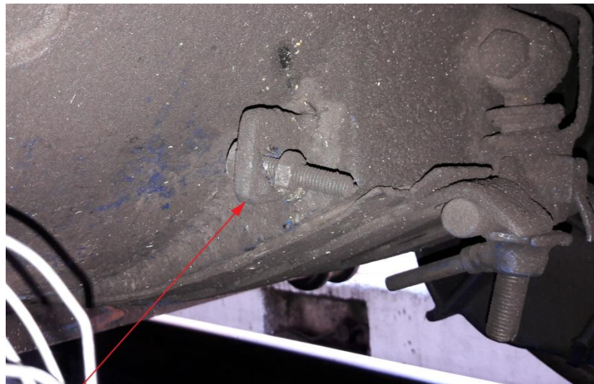
brida prindere cablu de siguranță
