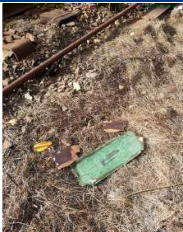
Foto nr.2 – Resturi din inductorul din cale și din inductorul locomotivei
