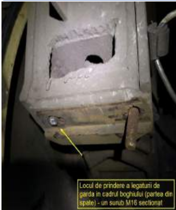
Foto nr.7 - Locul de prindere a plăcii legăturii de gardă în cadrul boghiului (partea din spate) - un șurub M16 sectionat
