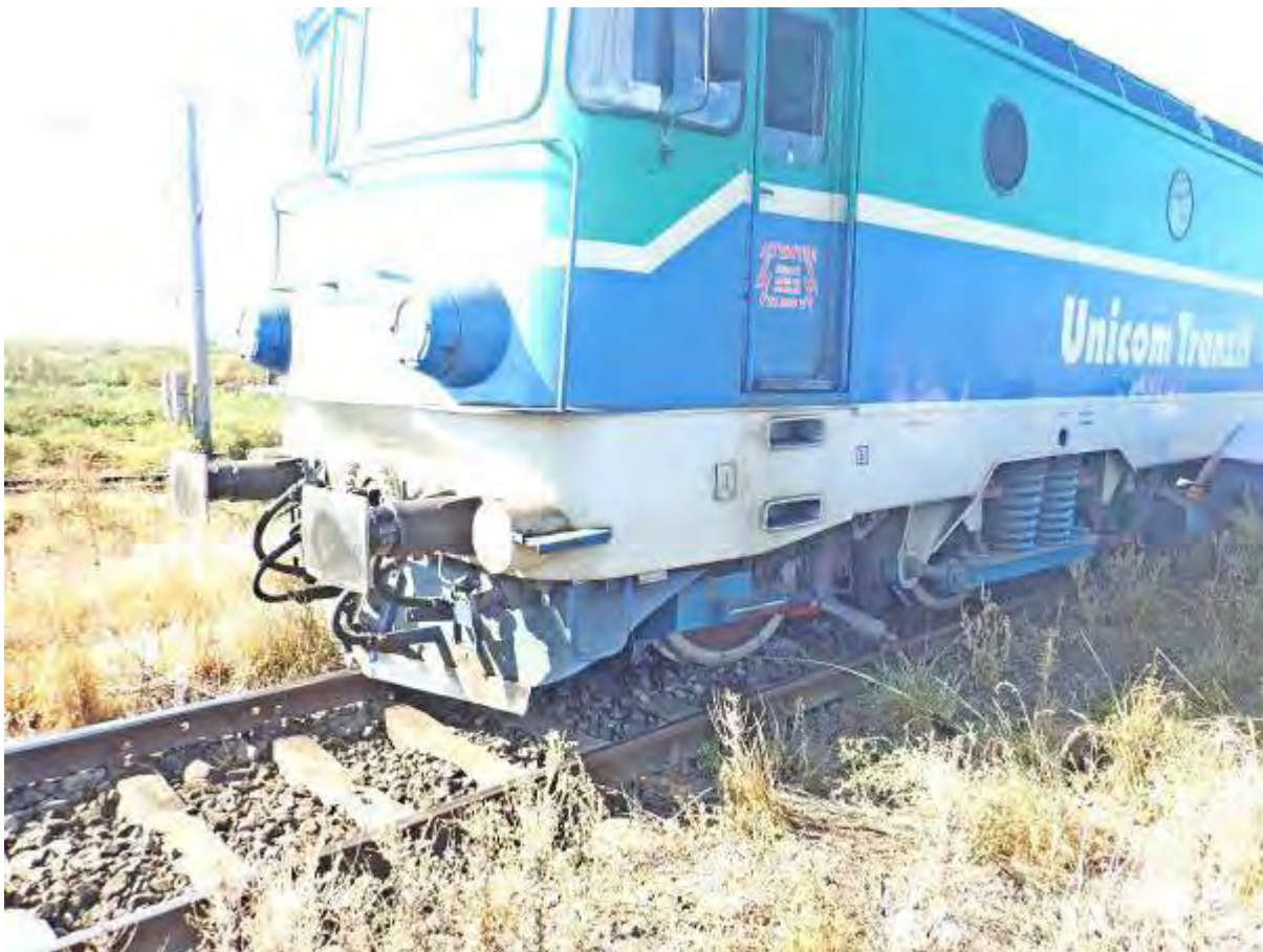
foto nr.1 - poziția locomotivei după deraiere
