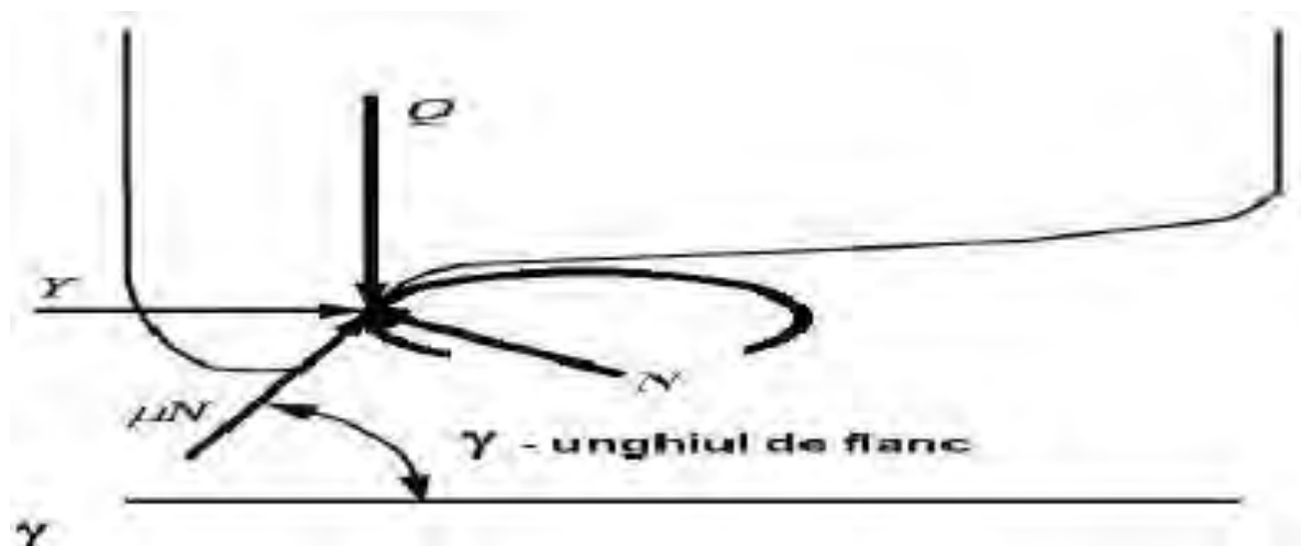
fig. 8: forțele ce acționează la contactul roată-șină
