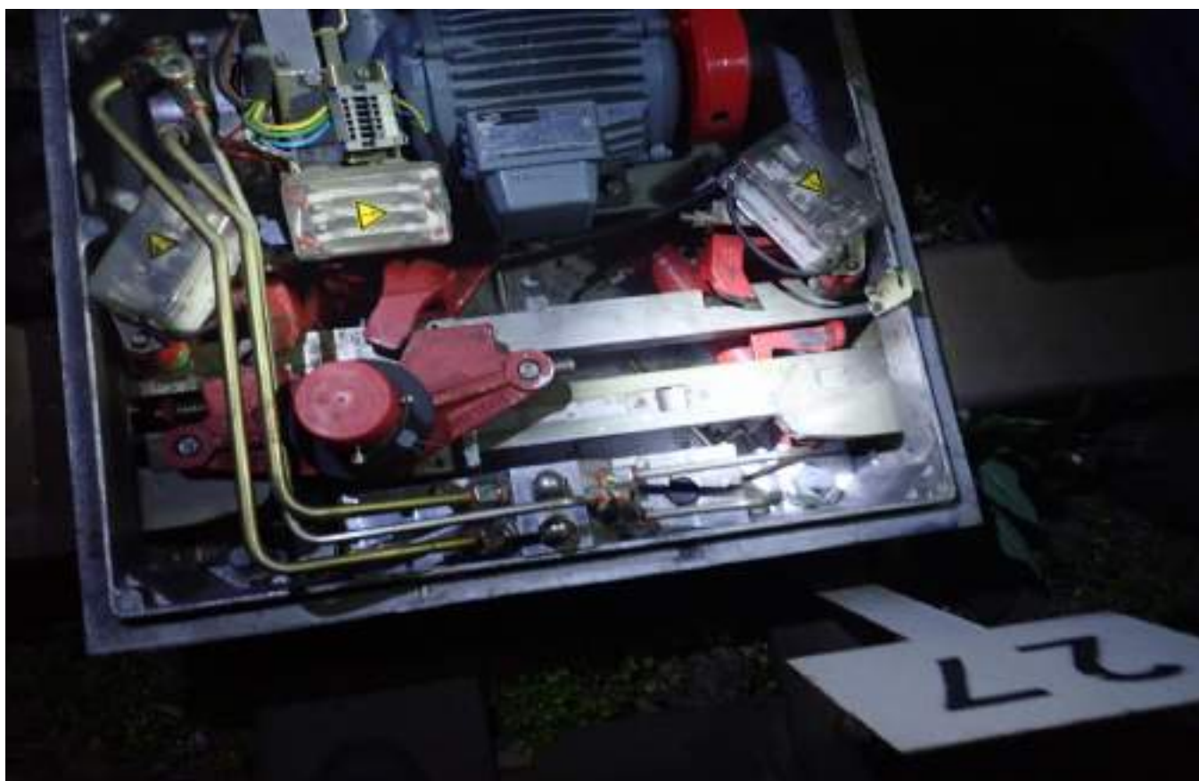
foto 5: electromecanismul de acționare a macazului schimbătorului de cale nr.27 – talonat
