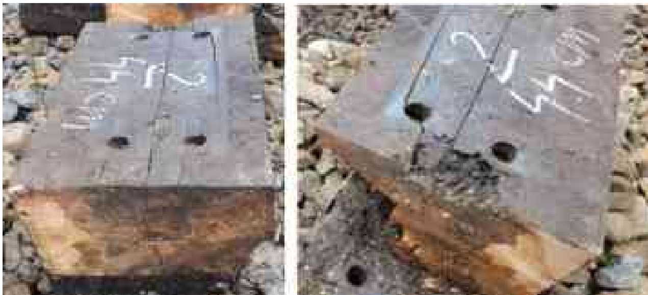
Imaginea 11 -fragmentul 2 - crăpături pe fața superioară și crăpătură în adâncime pe lungimea chitucului, lemn putrezit pe fața superioară și în interior
