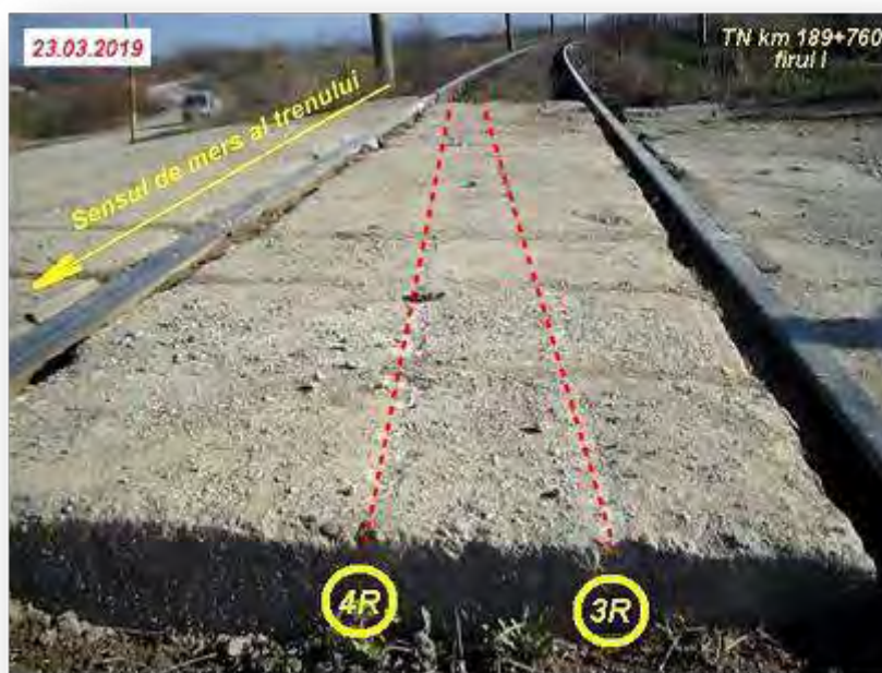
Foto nr.2 – Urmele produse de roțile 4R și 3R ale boghiului deraiat după escaladarea dalelor de beton interioare ale trecerii la nivel
