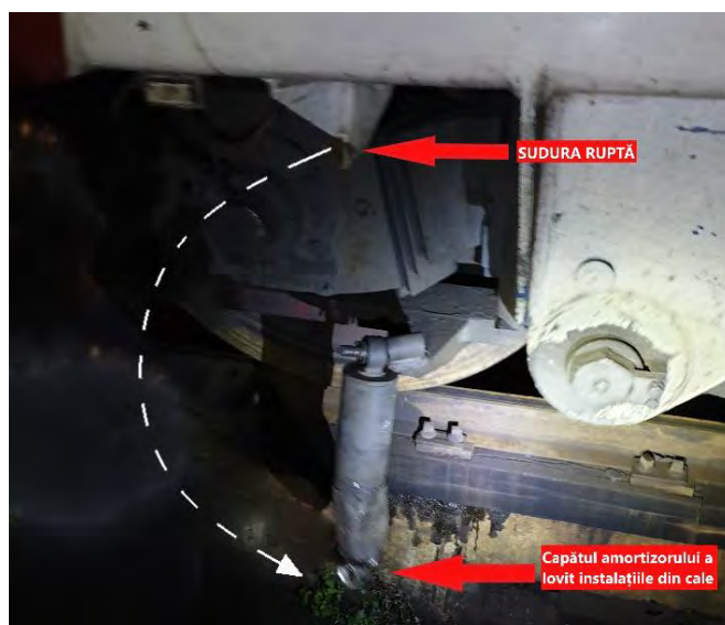
Imaginea 9 - Amortizorul hidraulic s-a rotit și a lovit instalațiile din cale (reconstituire). Poziția amortizorului după desprinderea din urechea superioară, amortizorul fiind susținut doar în articulația inferioară.
