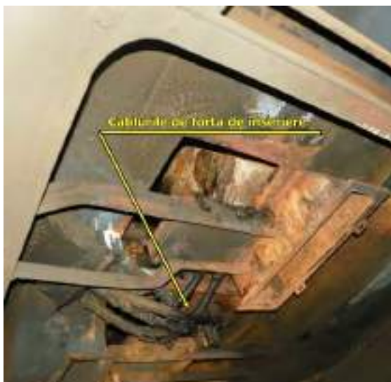
Fig. 11 Cablurile de forță, de inseriere, de la canalul de cabluri la MET nr.4
