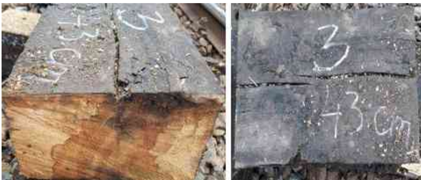
Imaginea 12 - fragmentul 3 - crăpături dinspre fața superioară spre interior, formare secțiuni de rupere
