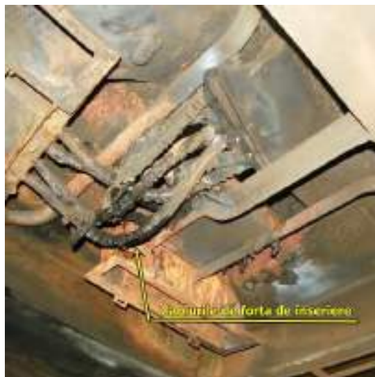
Fig. 12 Cablurile de forță de inseriere, de la canalul de cabluri la MET nr.5
