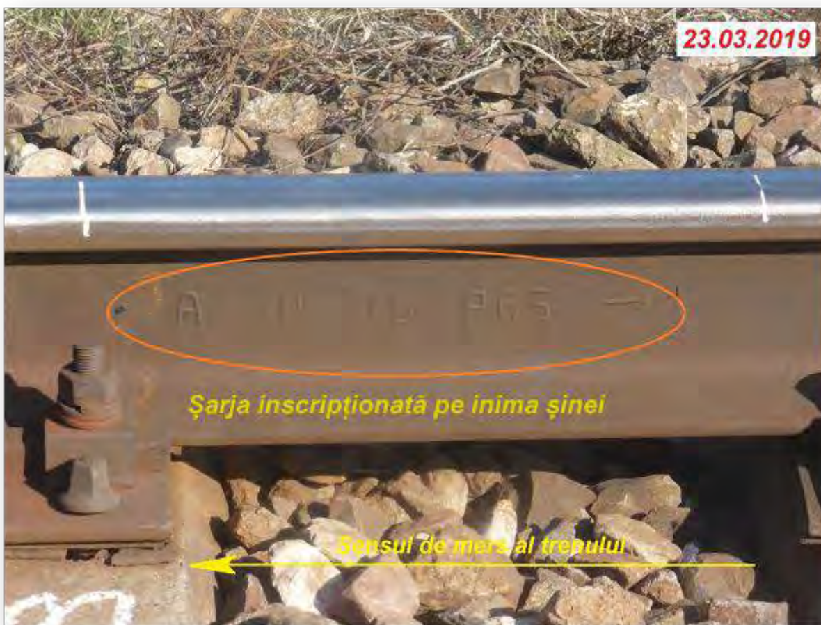
Foto nr.4 - Șarja inscripționată pe inima șinei cu rupere multiplă
