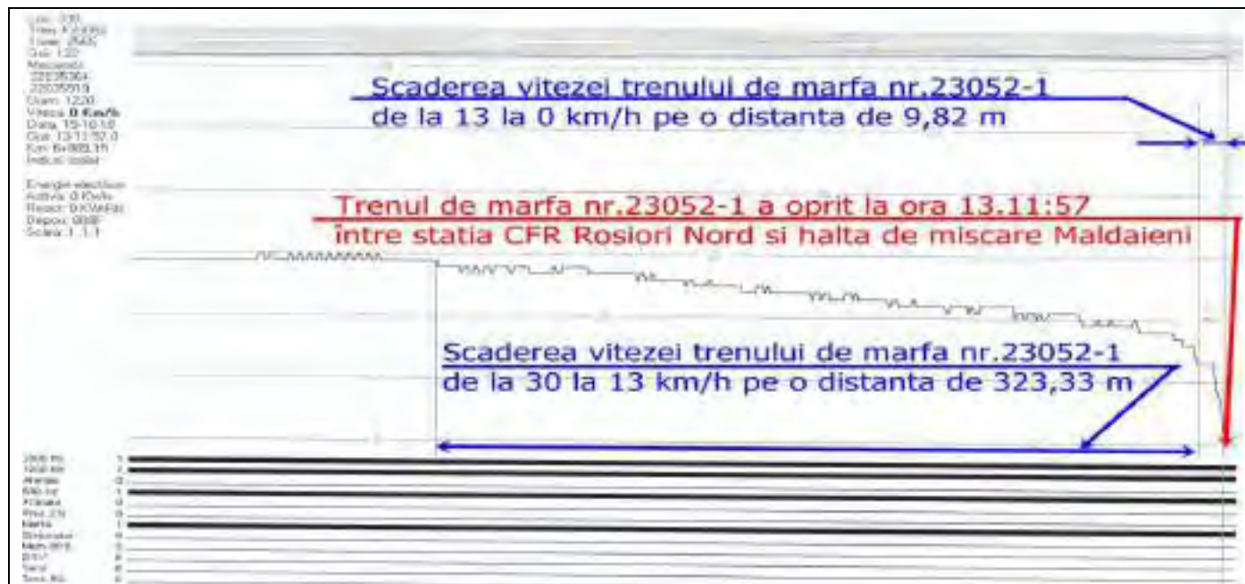
fig. 6: diagrama IVMS – EA 330 cu vitezele trenului înainte de producerea accidentului
