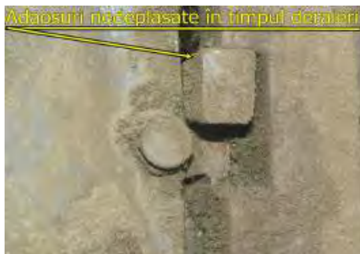
Fotografia nr.11 Adaosuri metalast roată osia nr.1 partea dreaptă sens de mers - față
