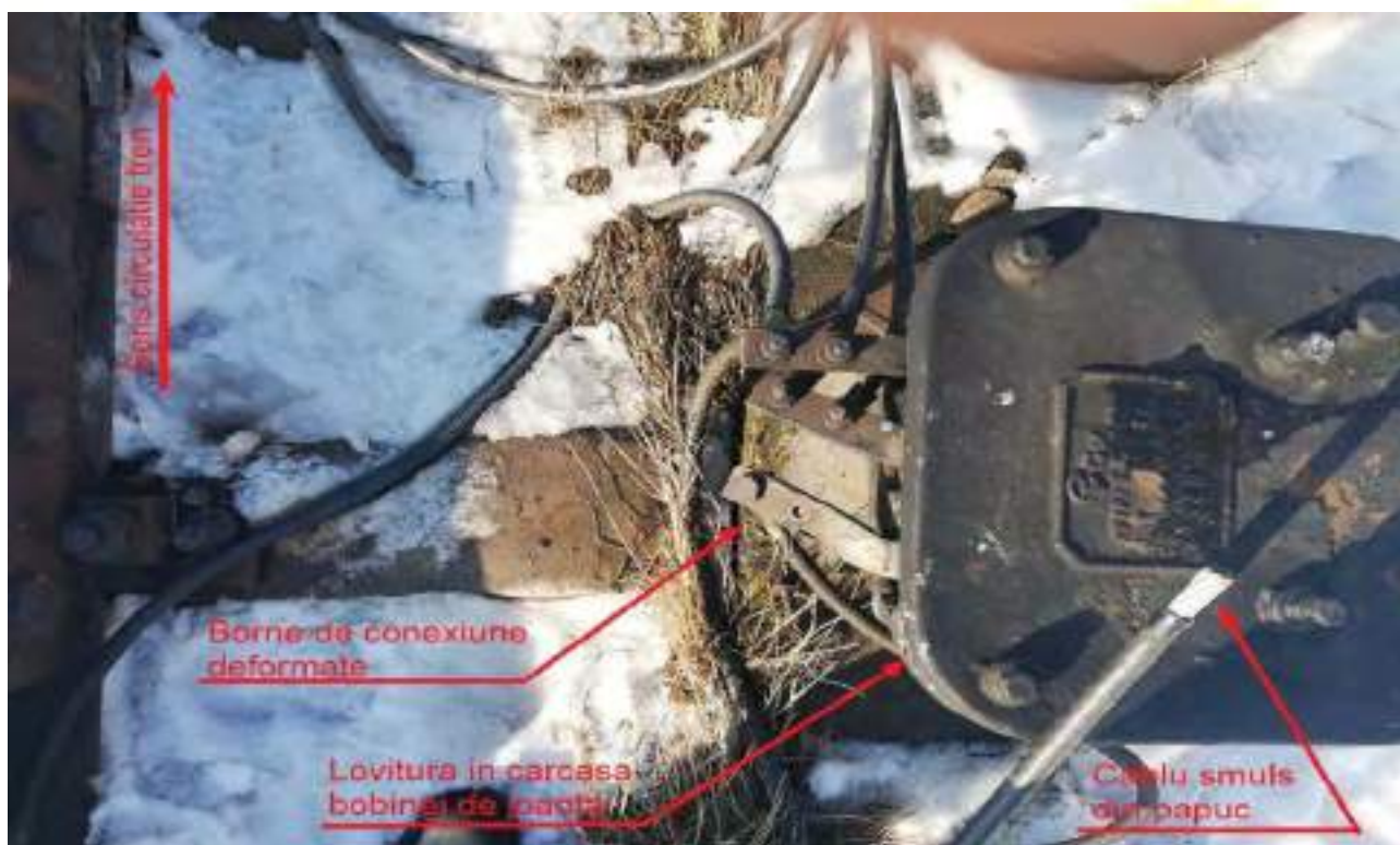
Foto nr.2 – Bobina de joantă de la km.367 +850 , cu cabluri smulse, conexiuni de deformate, carcasa lovită
