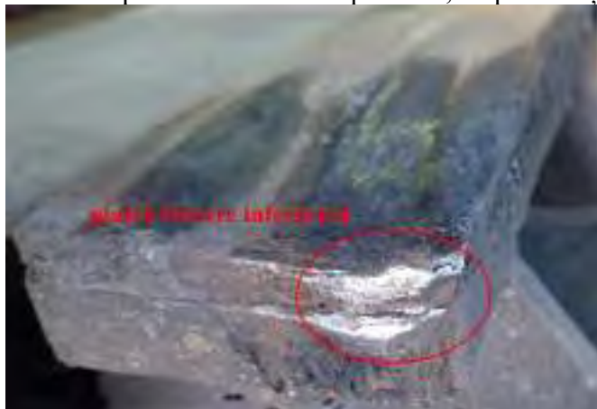
foto 14-15: pietrele de frezare inferioară și superioară de pe partea stângă a boghiului cu roțile 1÷4
