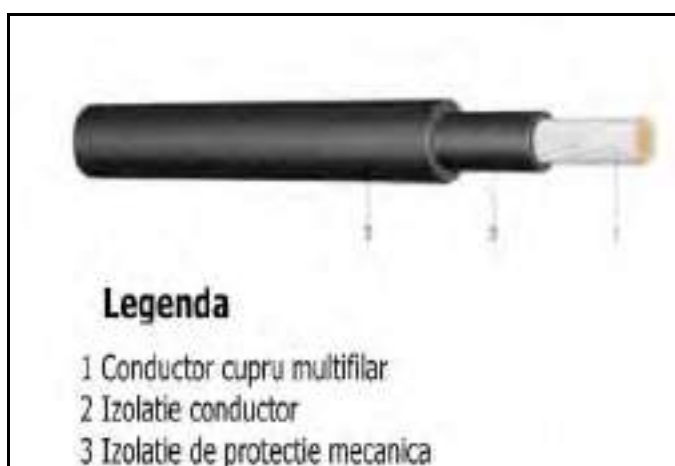
Fig. 14 Schiță structură cablaj forță
