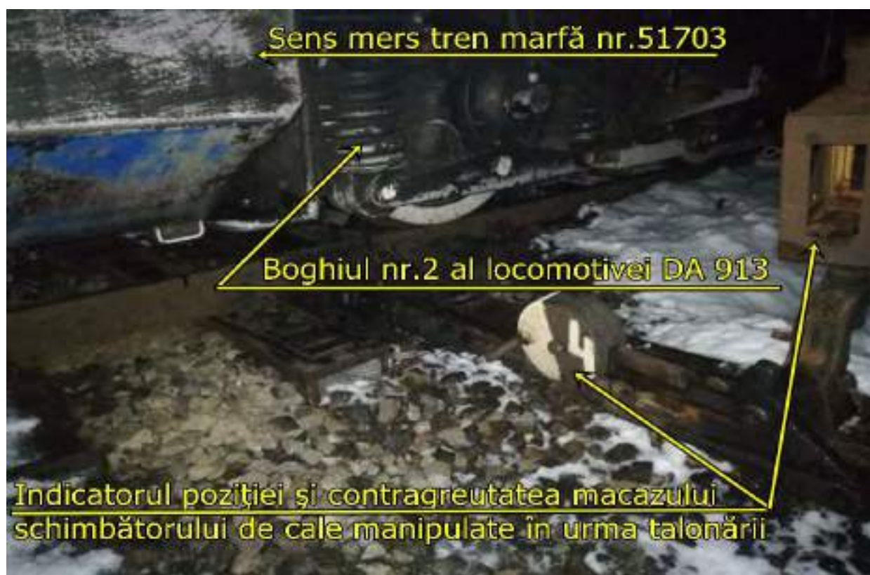
Fig.7 Aparatul de manevrare al macazului schimbătorului de cale nr.4
