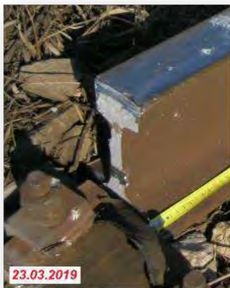
Foto nr.9 ÷13 – Secțiuni de rupere a șinei din cale
