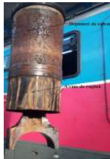
Fig. nr.7 Pistonul și cămașa cilindru nr.5
