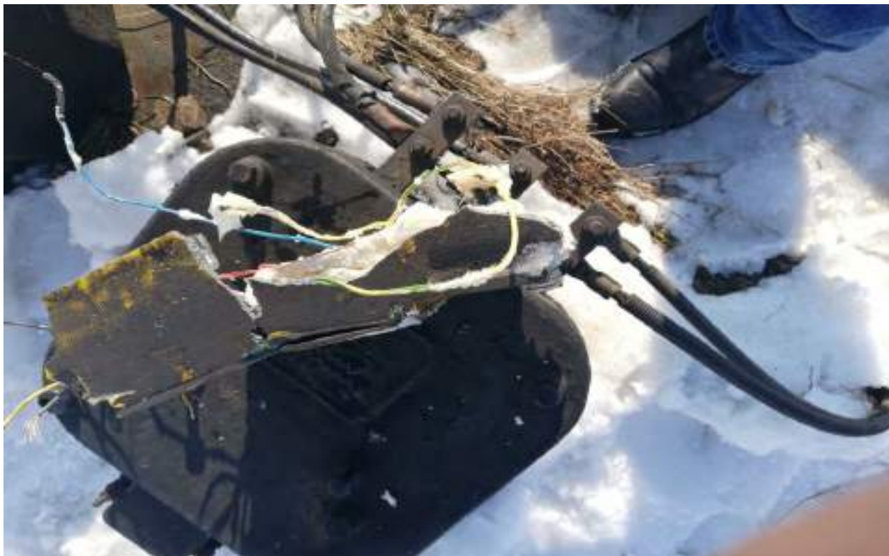
Foto nr.3 – Segment din inductorul distrus al locomotivei DA1272, poziționat pe carcasa bobinei de joantă
