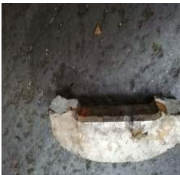
Foto nr.13 ÷14 – Fisură veche pe latura mică, partea superioară a furcii de suspensie
