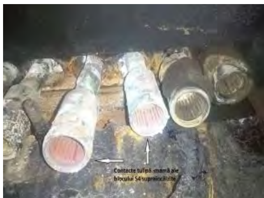
Foto nr.1 conectorii tip tulipă (M) din blocul S4
