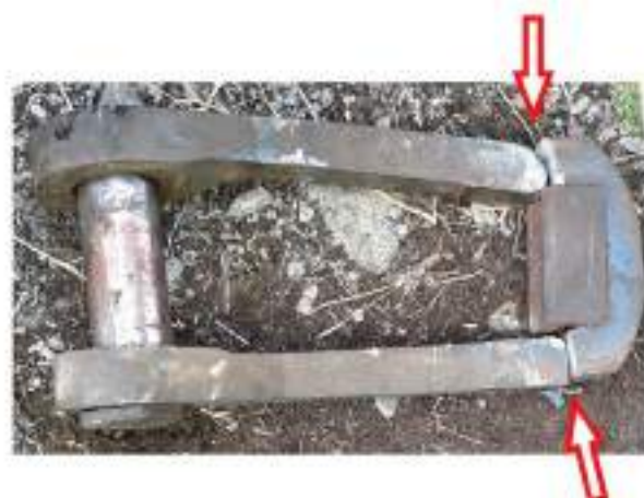
Imaginea 11 – poziția rupturilor pe brațele bridei pendulare de la DA 926 (reconstituire)
