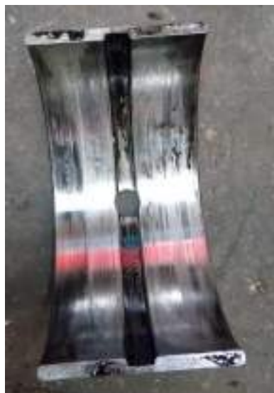
Fig. nr.6 Semicuzinet fără peliculă de ungere
