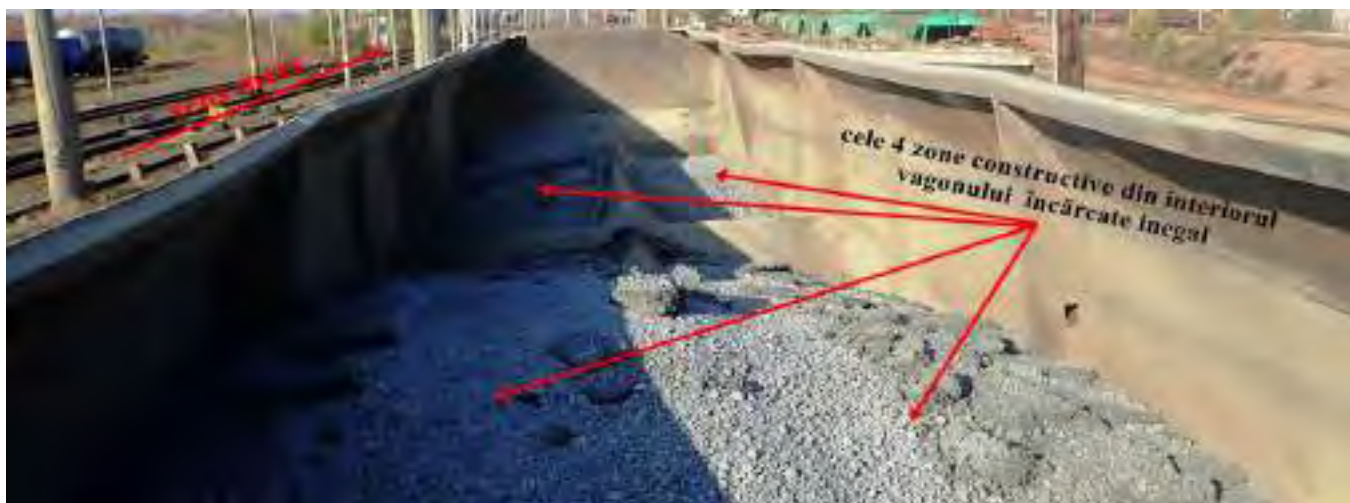
foto 17: aranjarea încărcăturii în vagonul nr.81536650964-5
