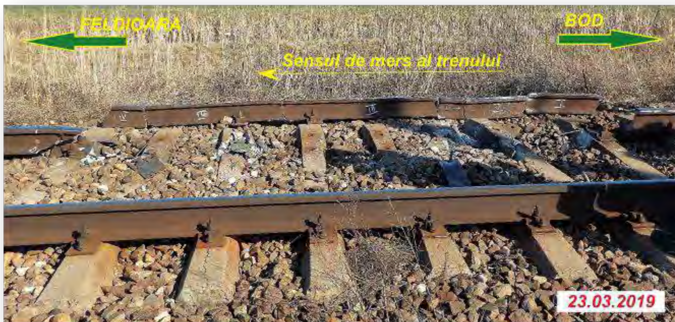
Foto nr.6 – Reconstituirea șinei cu ruperi multiple
