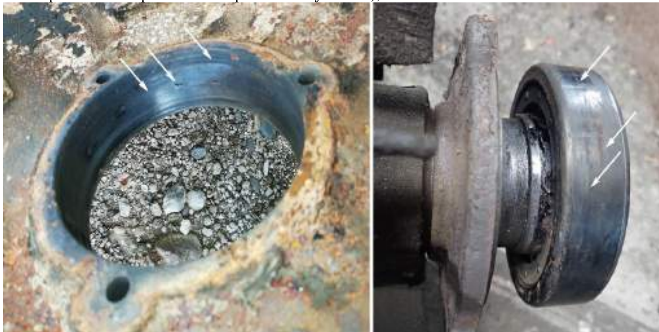
Foto nr.2: Urme de frecare pe rulment și pe scut.
