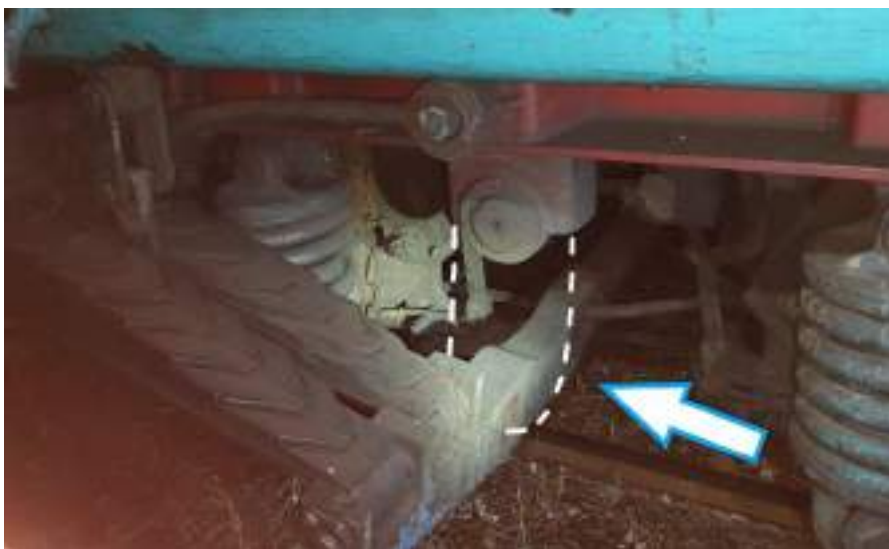
Imaginea 7 – Brida pendulară lipsea de la locomotiva DA 926 (linia albă punctată marchează locul de unde lipsea brida pendulară)
