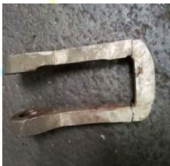
Foto nr.13 ÷14 – Fisură veche pe latura mică, partea superioară a furcii de suspensie
