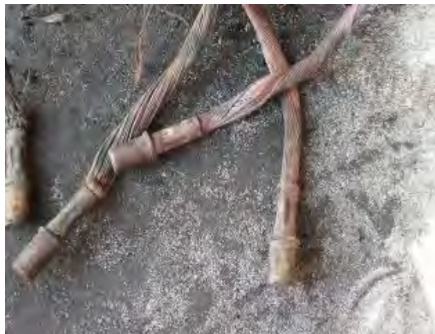
Foto nr.8 conectorii tip tulipă (T) supraîncălziți
