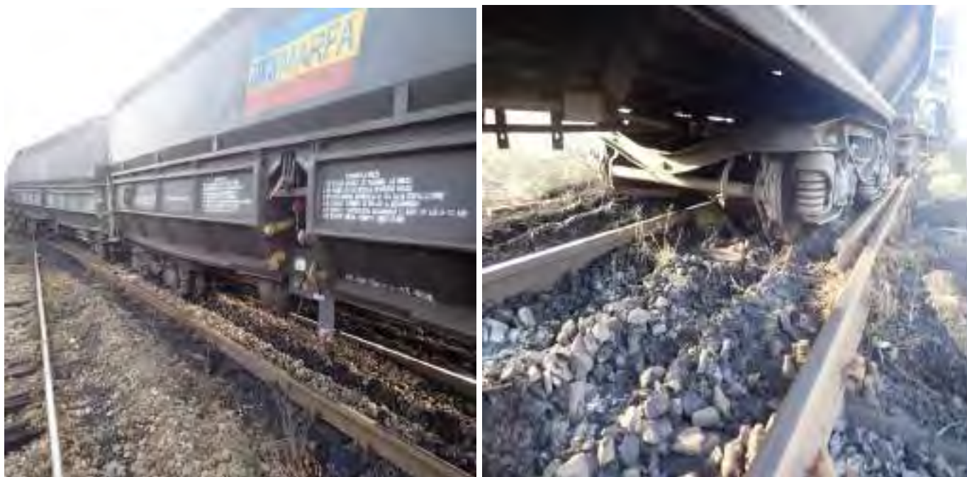
foto nr. 8,9: poziția vagoanelor deraiate, la momentul opririi trenului
