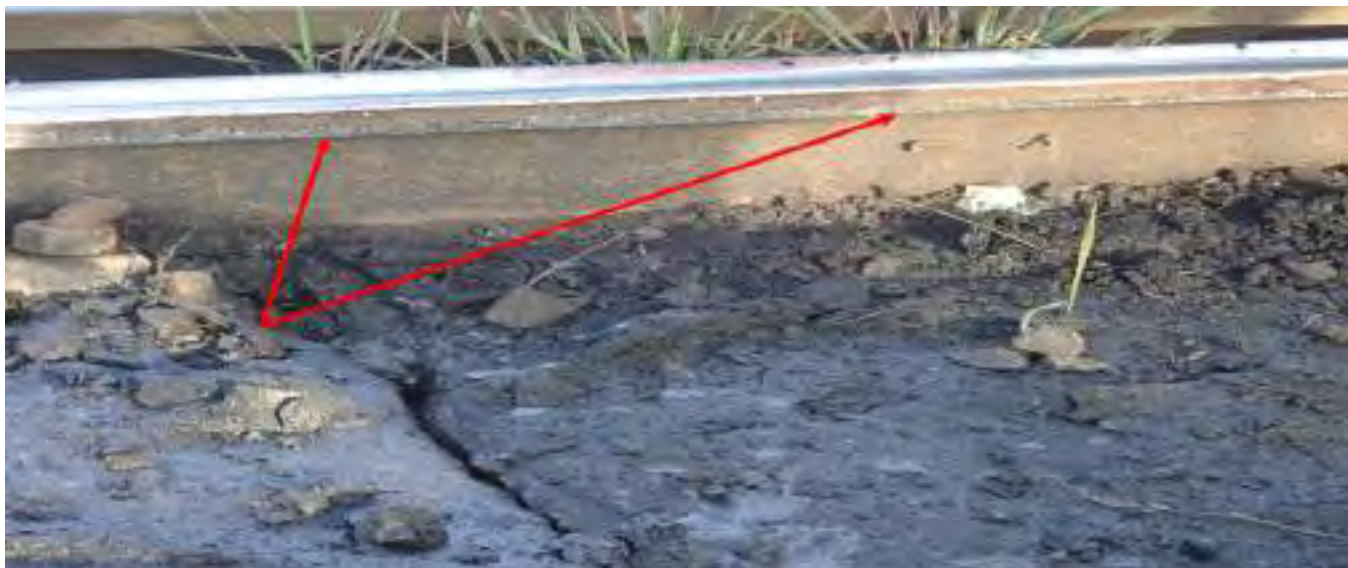
foto nr. 12: urme de frecare a roții R 5 pe flancul activ al ciupercii șinei
