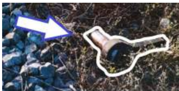
Imaginea 5 – Bulon și braț de la brida pendulară, găsite pe terasamentul căii ferate
