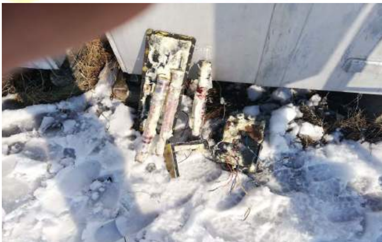
Foto nr.4 – Segmente din inductorul distrus al locomotivei DA1272, partea (fața) inferioară și parțial partea superioară
