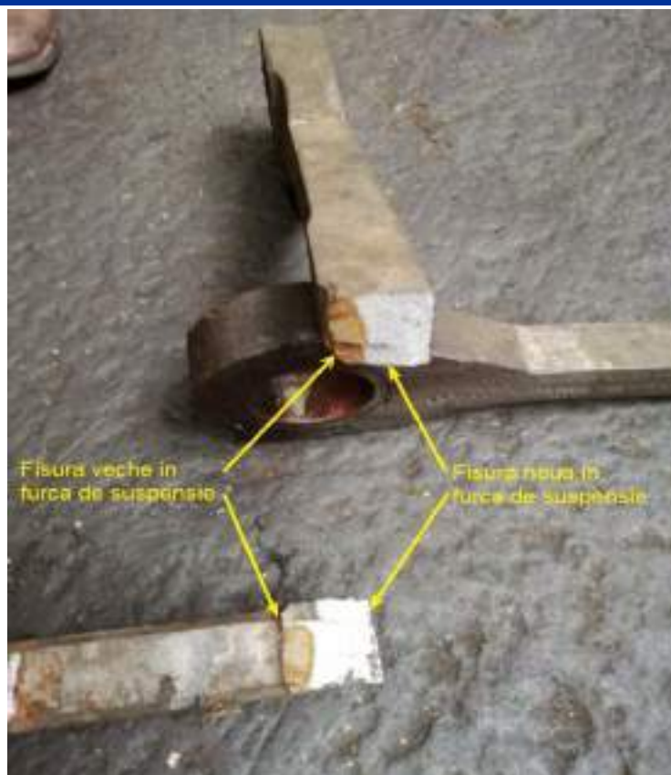
Foto nr.8 – Furca de suspensie ruptă, cu ruptură veche de 25% din suprafața secțiunii
