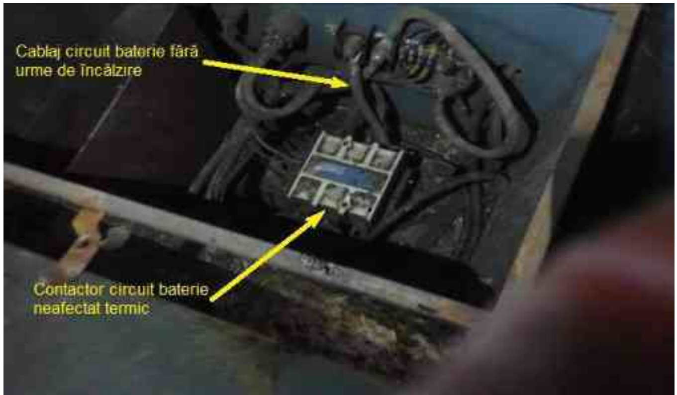
Foto nr.10 – Contactorul din circuitul bateriilor de acumulatori
