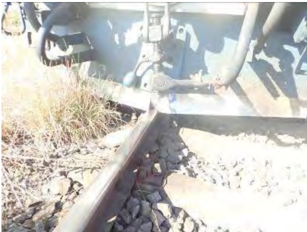
Foto nr.5 – poziția plugului locomotivei deraiate
