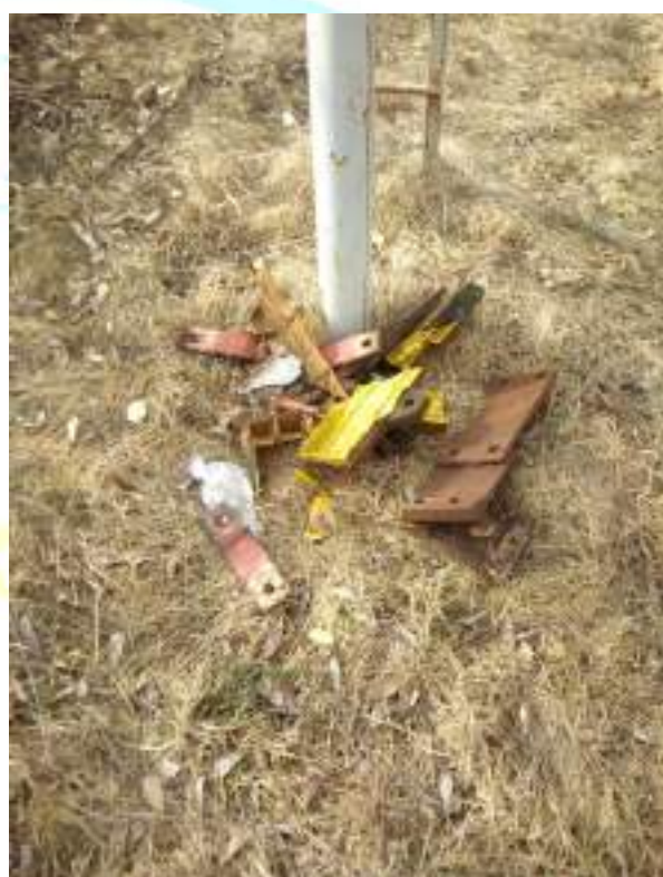
Foto nr.4 – Părți ale inductorului din cale și ale apărătoarei metalice de protecție, desprinse din prinderea de pe șină
