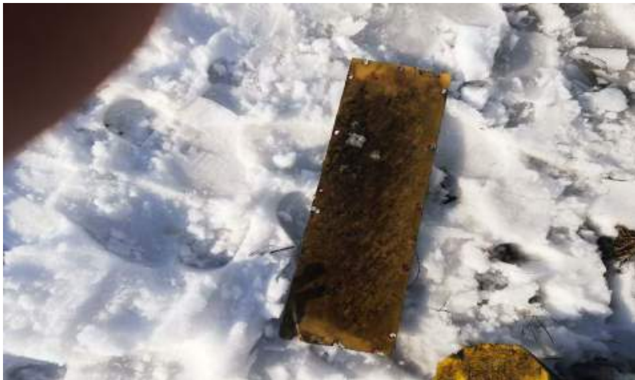
Foto nr.5 – Partea (fața) inferioară din inductorul distrus al locomotivei DA1272, așa cum a fost constatată în zona pasajului de trecere la nivel cu calea ferată
