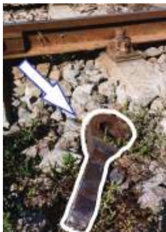
Imaginea 4 – Braț de la brida pendulară, găsit pe terasamentul căii ferate
