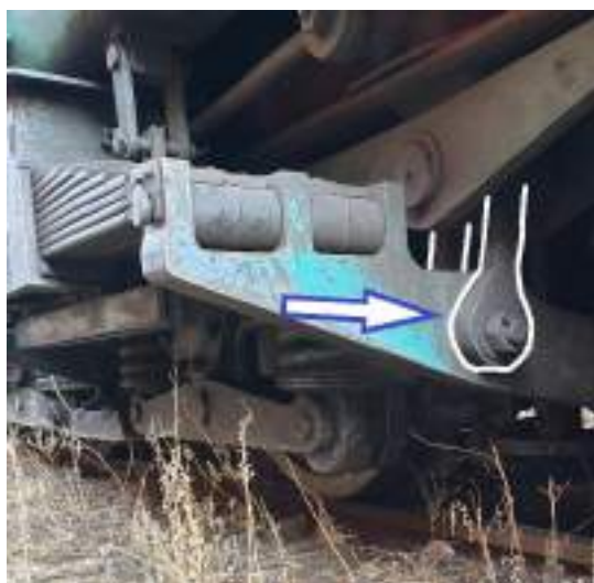
Imaginea 9 – Exemplificare de bridă pendulară, montată în poziție normală de funcționare
