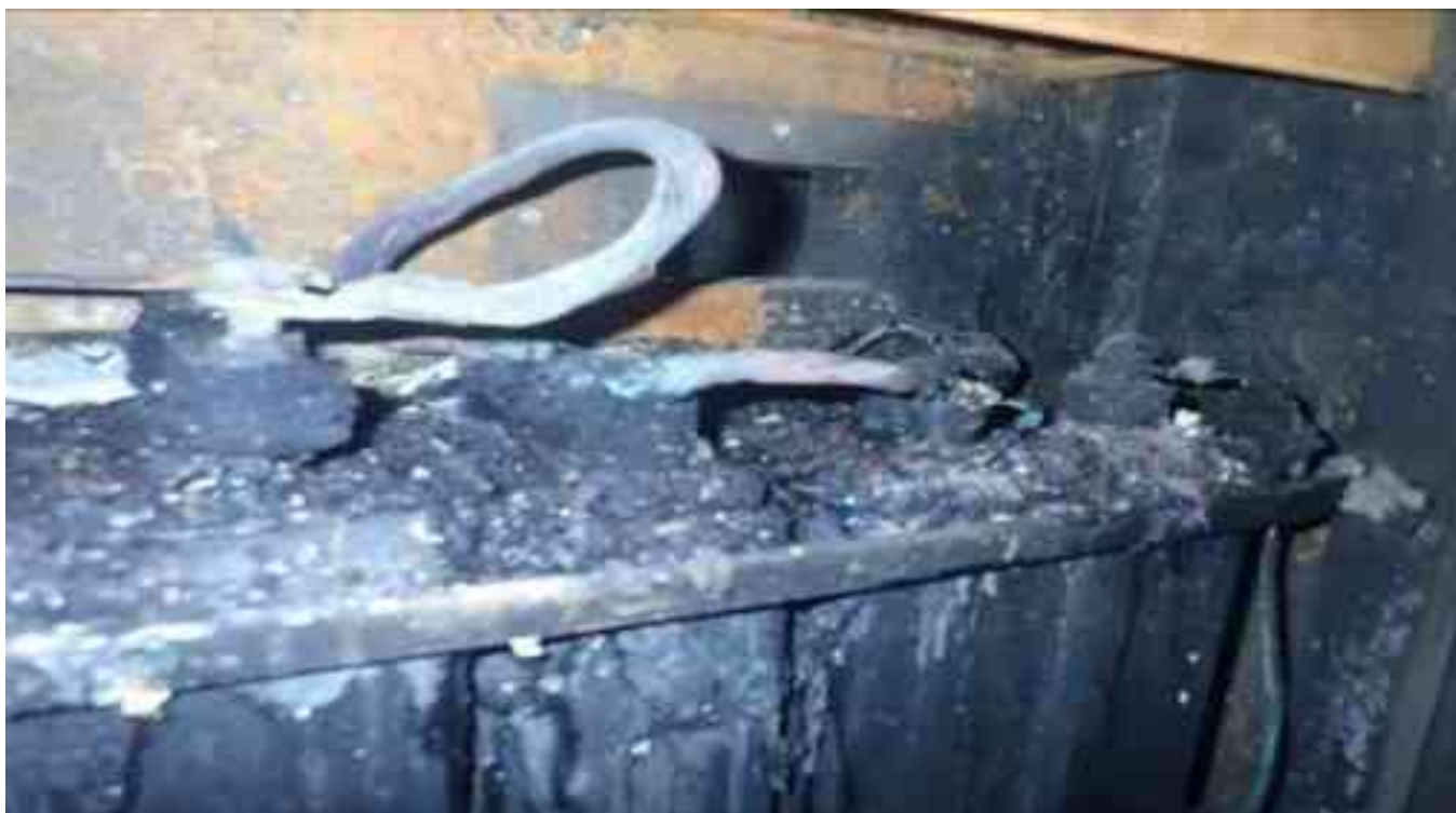
Foto nr.3 – Baterii de acumulatori cu depuneri de material ars.
