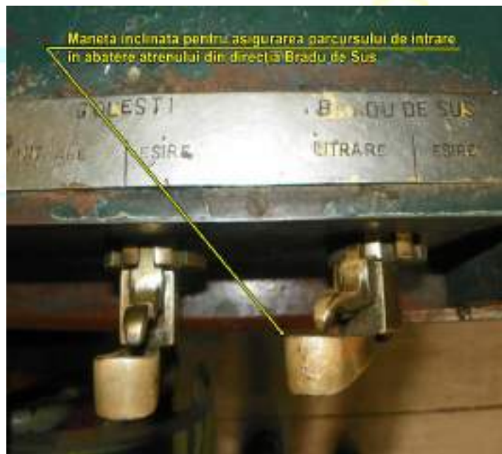
Fig. 10 Cutia mecanică a blocului SBW, partea cu manete de la cabina nr.3
