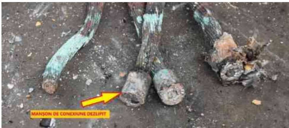
Imaginea. nr.9 - manșoanele de conexiune dezlipite
