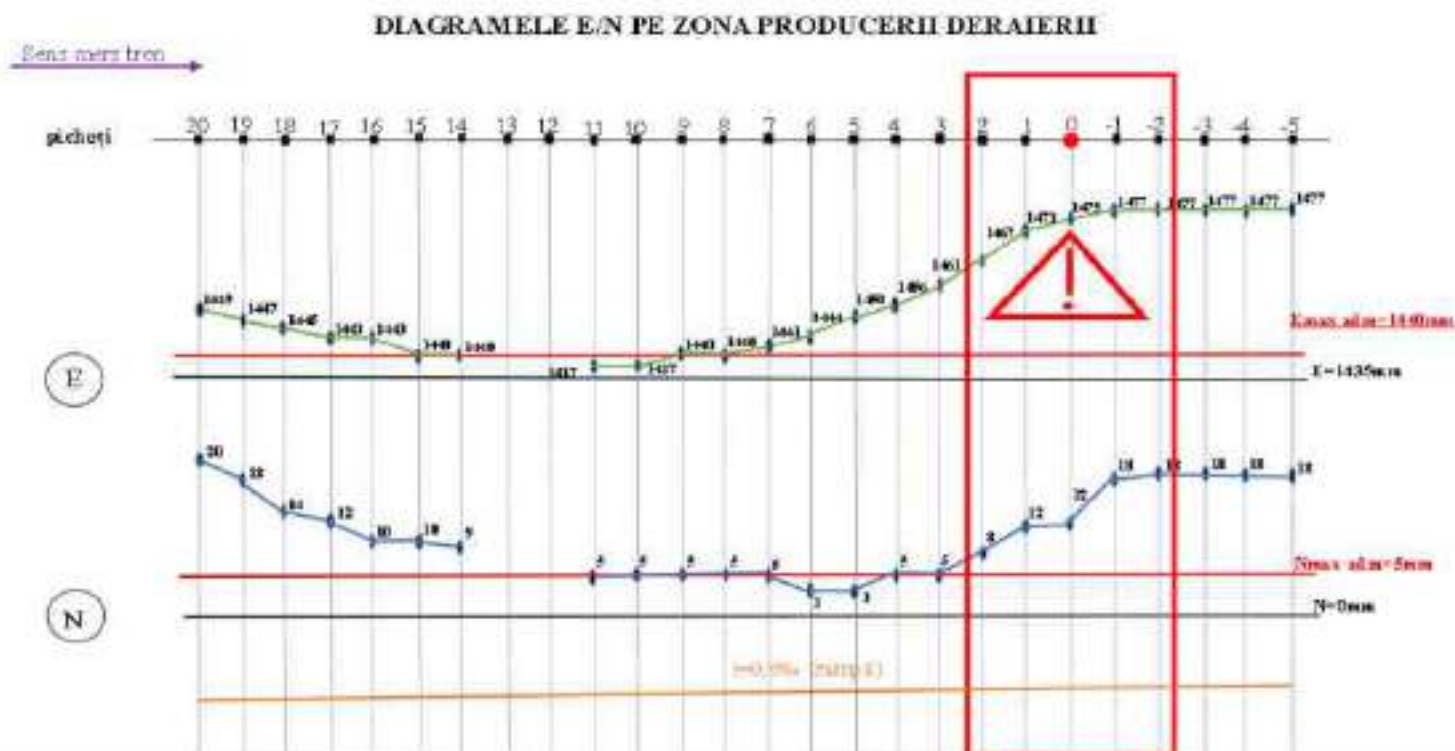
fig. nr. 3: diagrama E/N pe zona producerii accidentului
