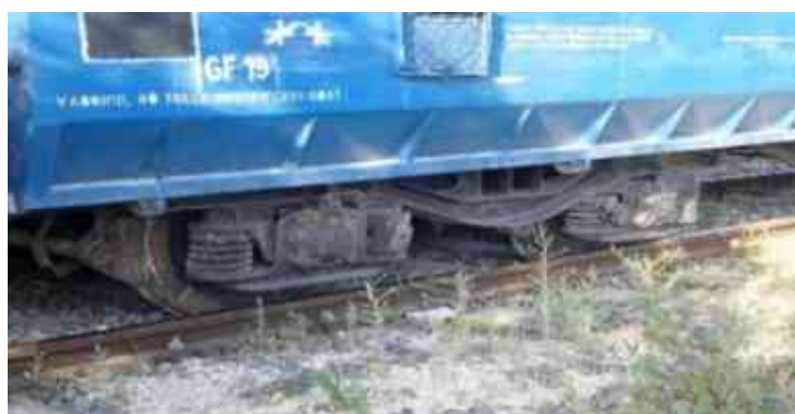
Foto nr.3 Poziția osiilor în interiorul căii de la vagonul al 11-lea de la locomotivă
