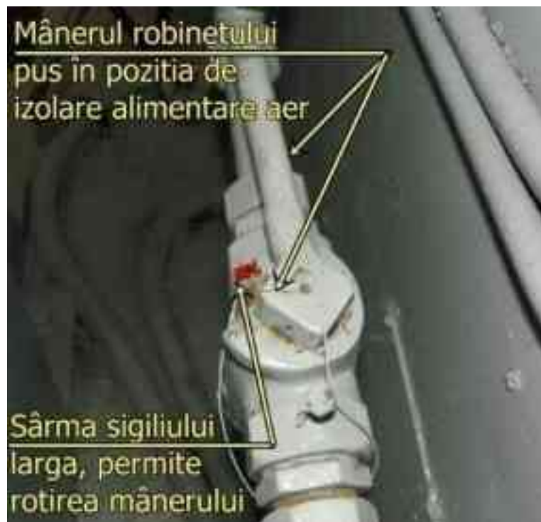
Foto nr.5. – Robinet izolare INDUSI EA 691
