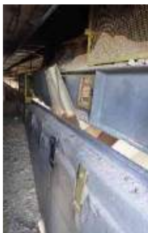
Foto nr.12 Calcar căzut din buncărul de încărcare
