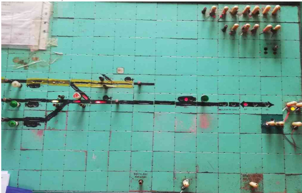
Fig.4 Semnalizările de pe aparatul de comandă
