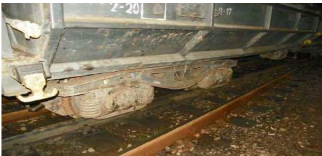
foto nr.8: poziția vagonului după deraiere
