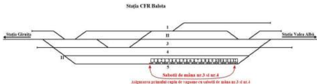
fig. nr.3: așezarea saboților de mână în vederea asigurării primului cuplu de vagoane
