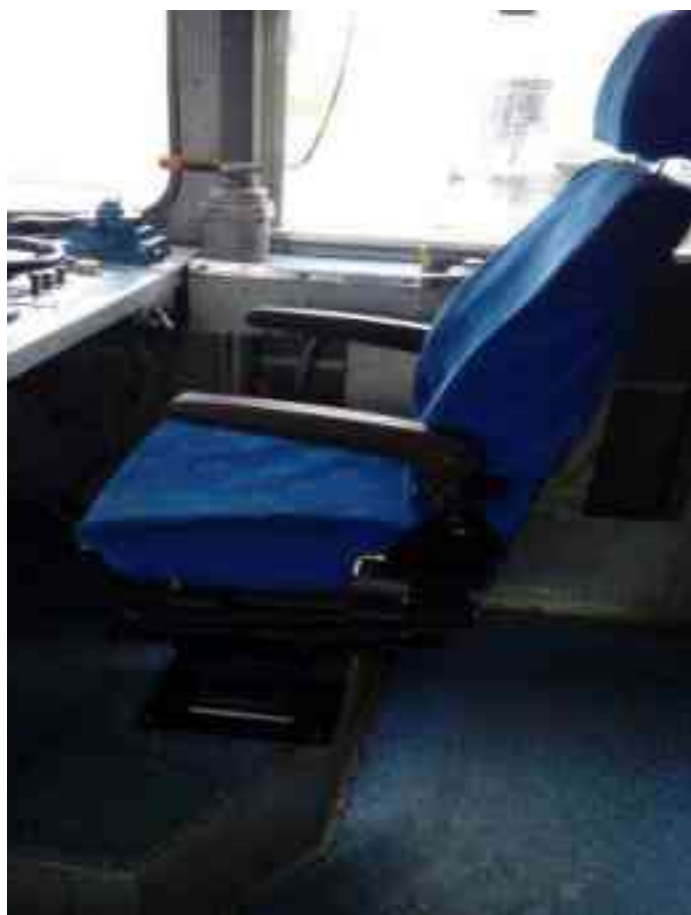
Foto. nr.12 Poziția scaunului mecanicului din postul I de conducere după montaj la EA 691
