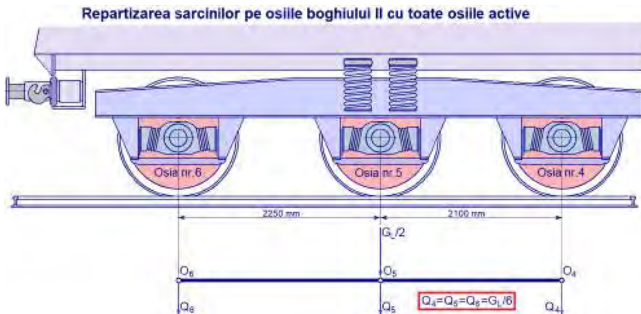
Fig. nr.3 – Situația când toate cele 3 osii sunt pe șină. Sarcina este aproximativ egal distribuită pe cele trei osii
