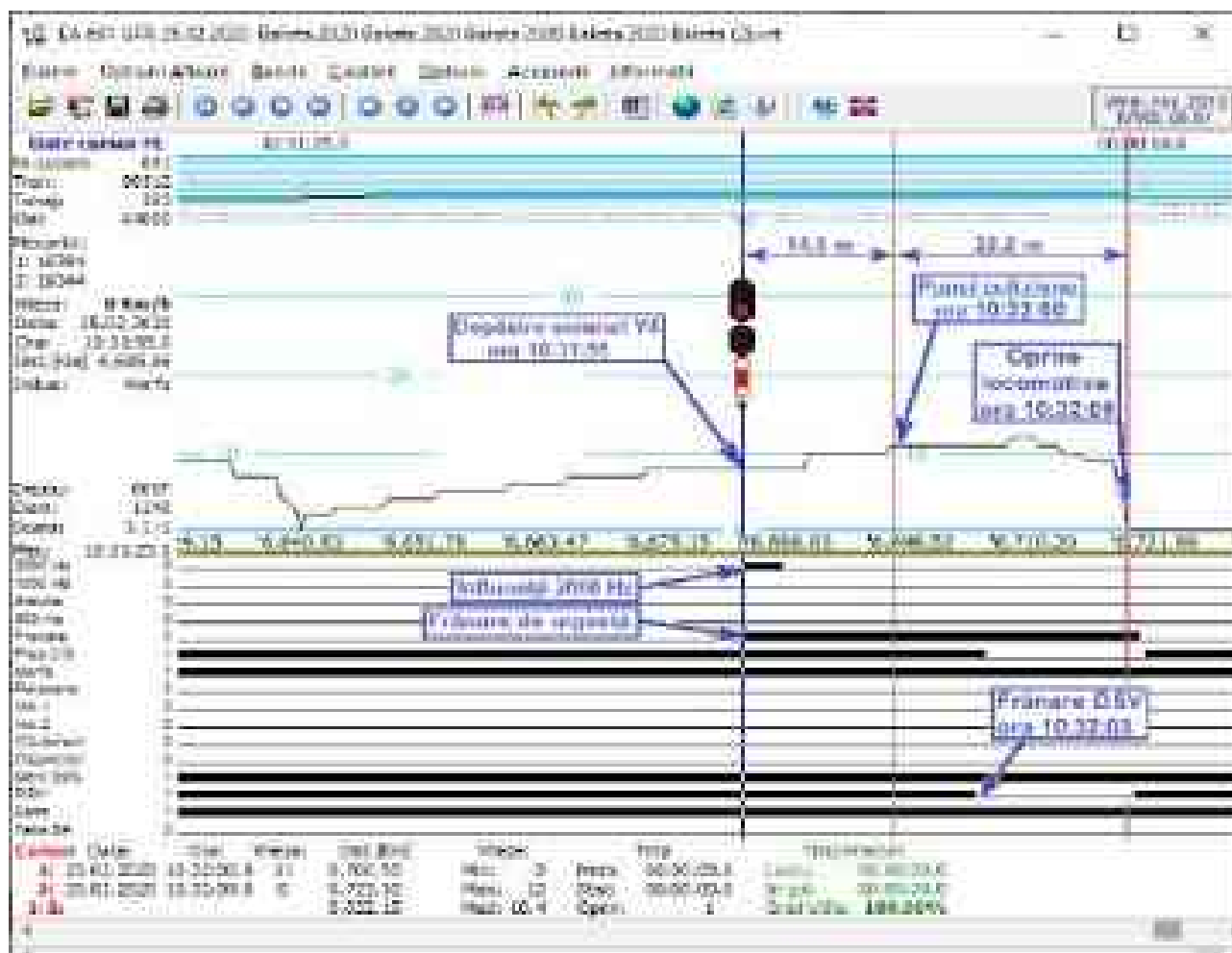
Fig.8 Diagrama instalației de vitezometru IVMS – EA 691
