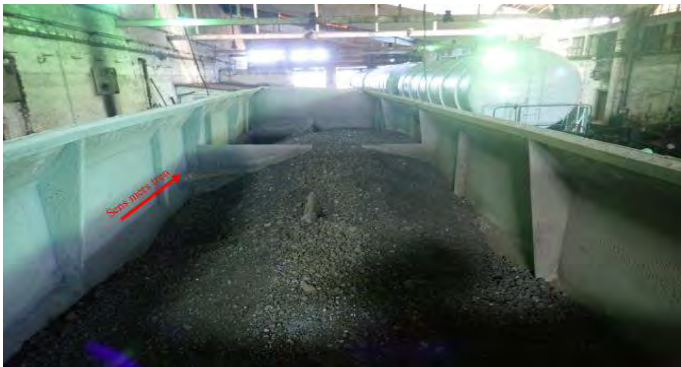
foto nr.11: starea celor 4 zone (compartimente) ale vagonului la momentul producerii deraierii
