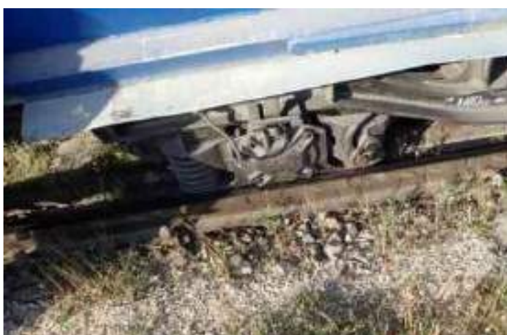
Foto nr.2 Poziția osiilor în interiorul căii de la vagonul 5 de la locomotivă
