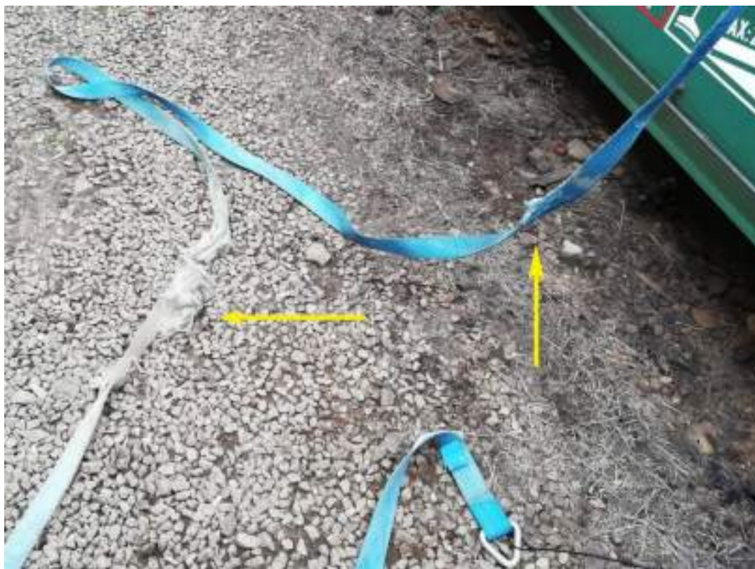
Foto nr.4. Curea degradată ca urmare a frecării cu terasamentul și tăiată parțial.
