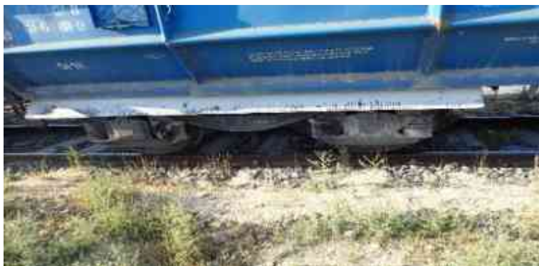
Foto nr.4 Poziția osiilor în interiorul căii de la vagonul al 12-lea de la locomotive
