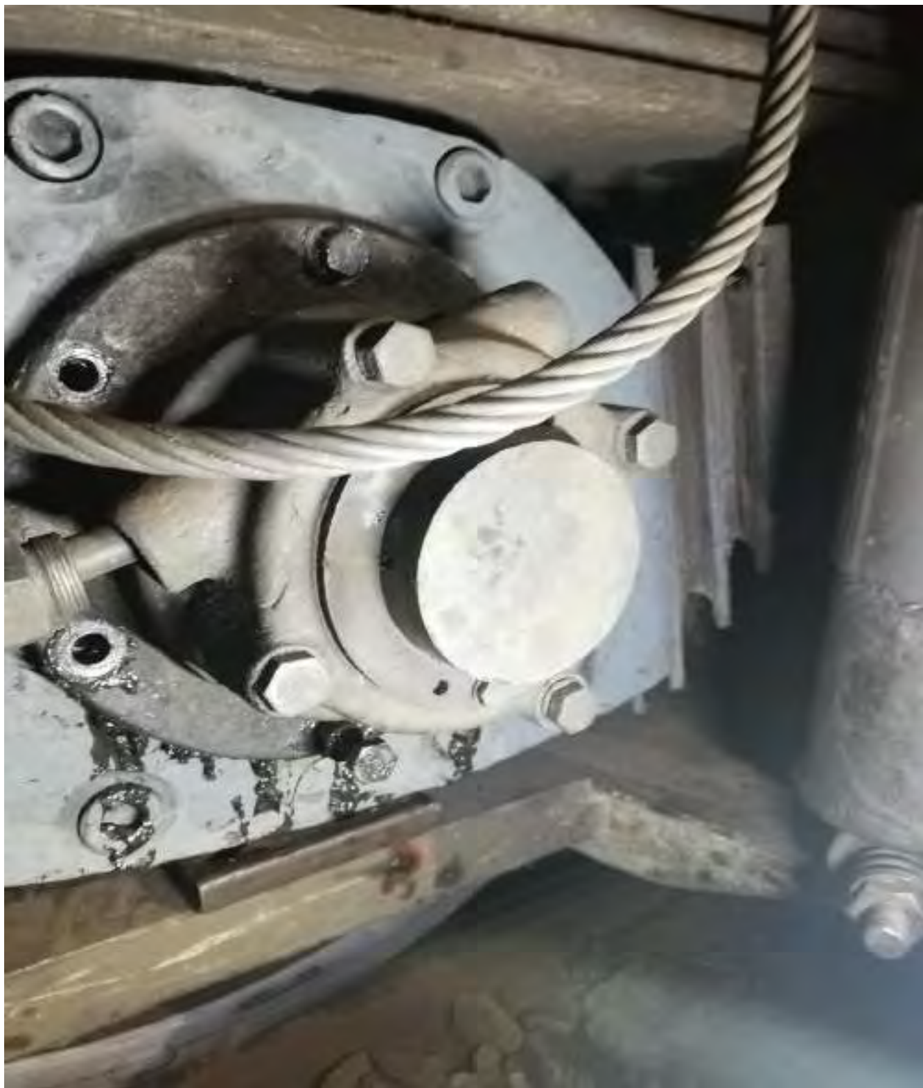
Foto nr.8 – Osia nr.4 partea stângă, calaj realizat prin introducerea de plăci metalice între placa de gardă și cutia de unsoare. Se pot observa și urmele lăsate la desfacerea prizoanelor capacului de osie pentru verificarea rulmentului
