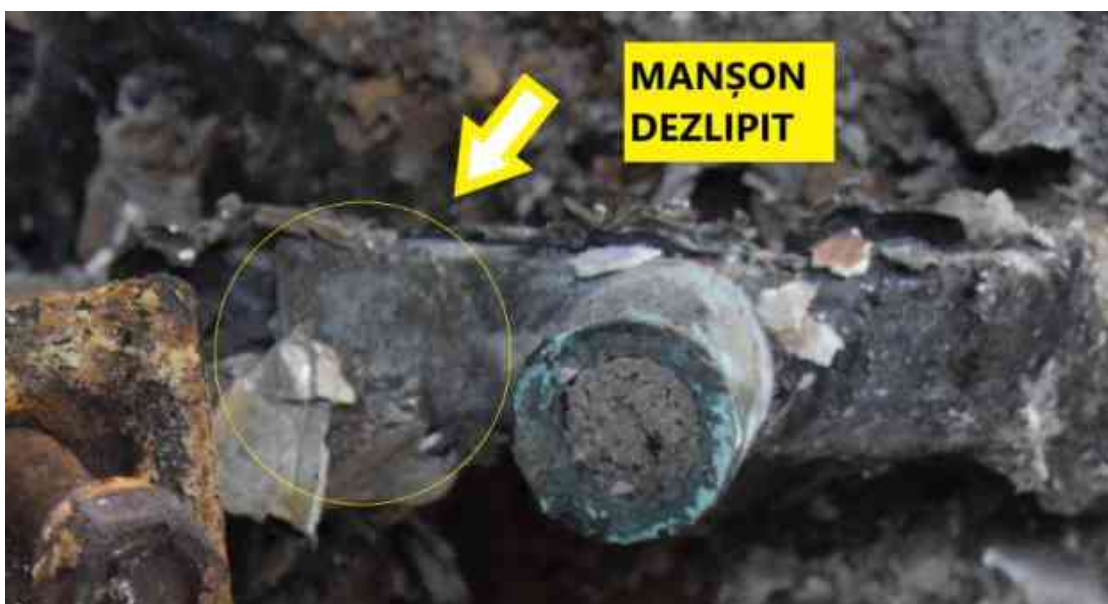
Imaginea. nr.7- – urma lăsată de un manșon dezlipit la MET 6
