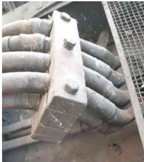
Imaginea. nr.5 - materialul lemnos de la bridă și matisajul aplicat peste manșoane (exemplu)
