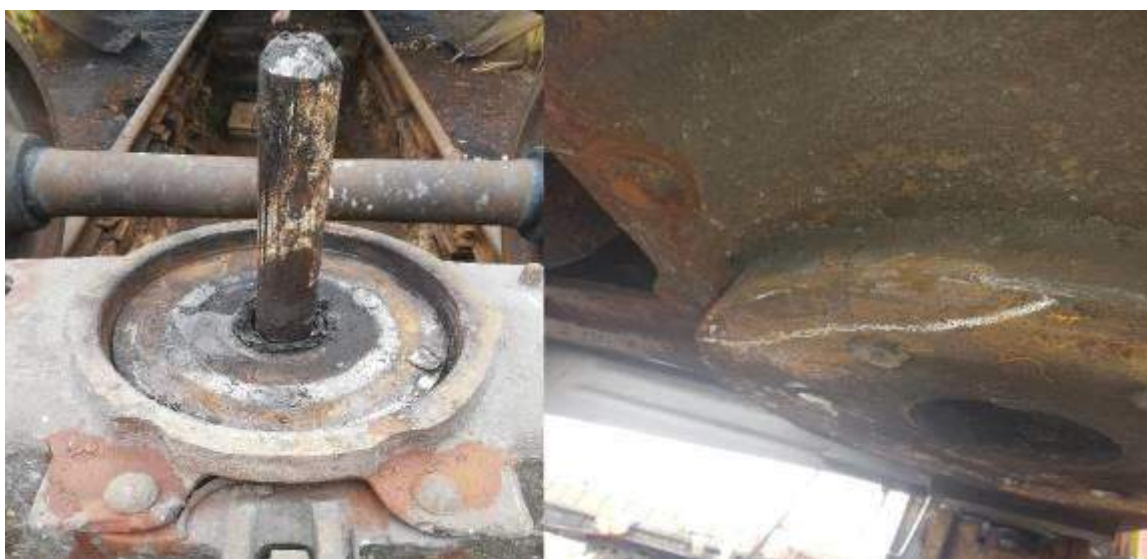
Foto nr.3- ansamblu crapodină inferioară, crapodină superioară de la boghiul nr. 1
