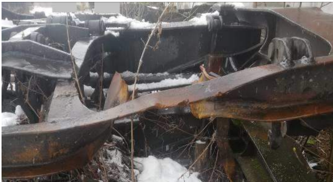
Foto nr.15 – cadrul de boghiu deformat
