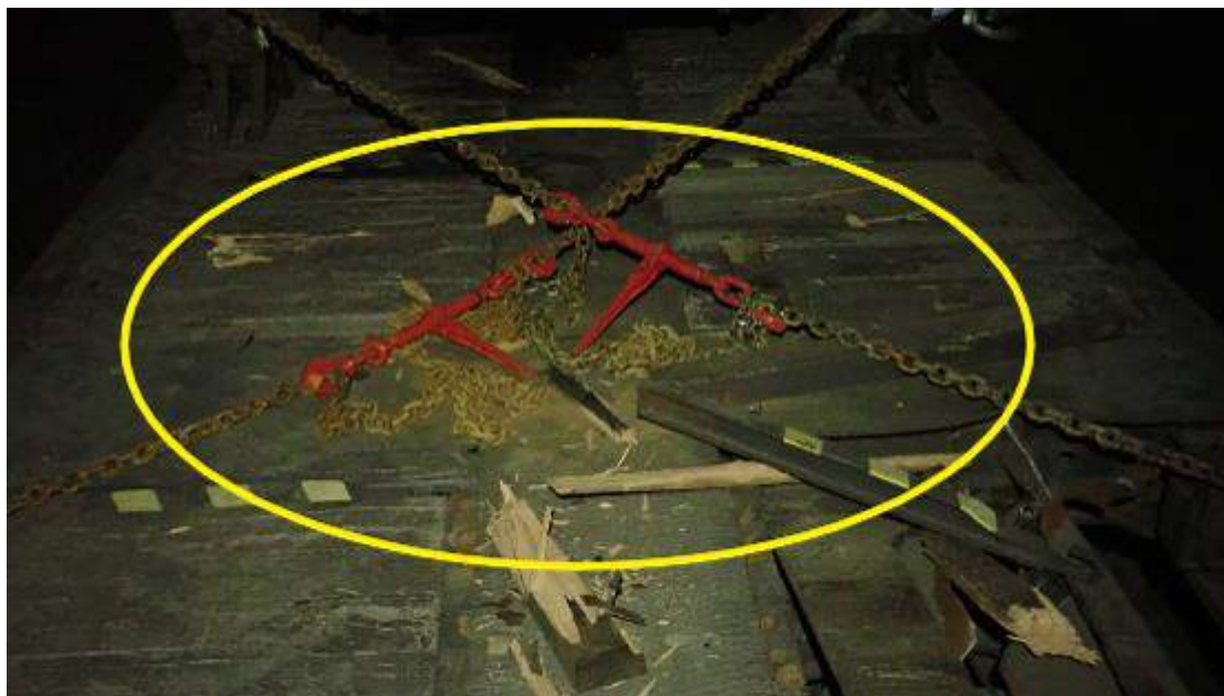
Foto nr.19 – zona unde era poziționat surplusul de lanțuri la vagonul deraiat
