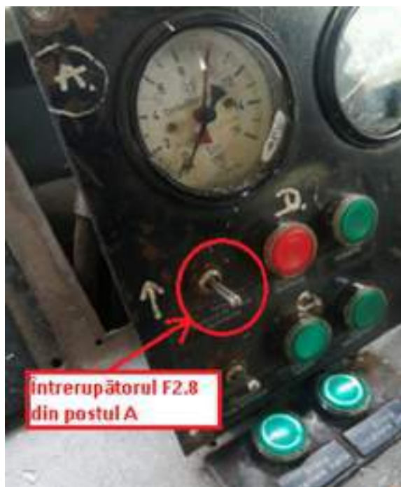
Foto nr.4 - întrerupătorul F2.8 postul A era în poziția „deschis” (coborât)
