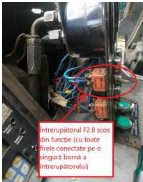
Foto nr.5 - întrerupătorul F2.8 postul A era scos din funcție, avea toate firele conectate pe o singură bornă a întrerupătorului
