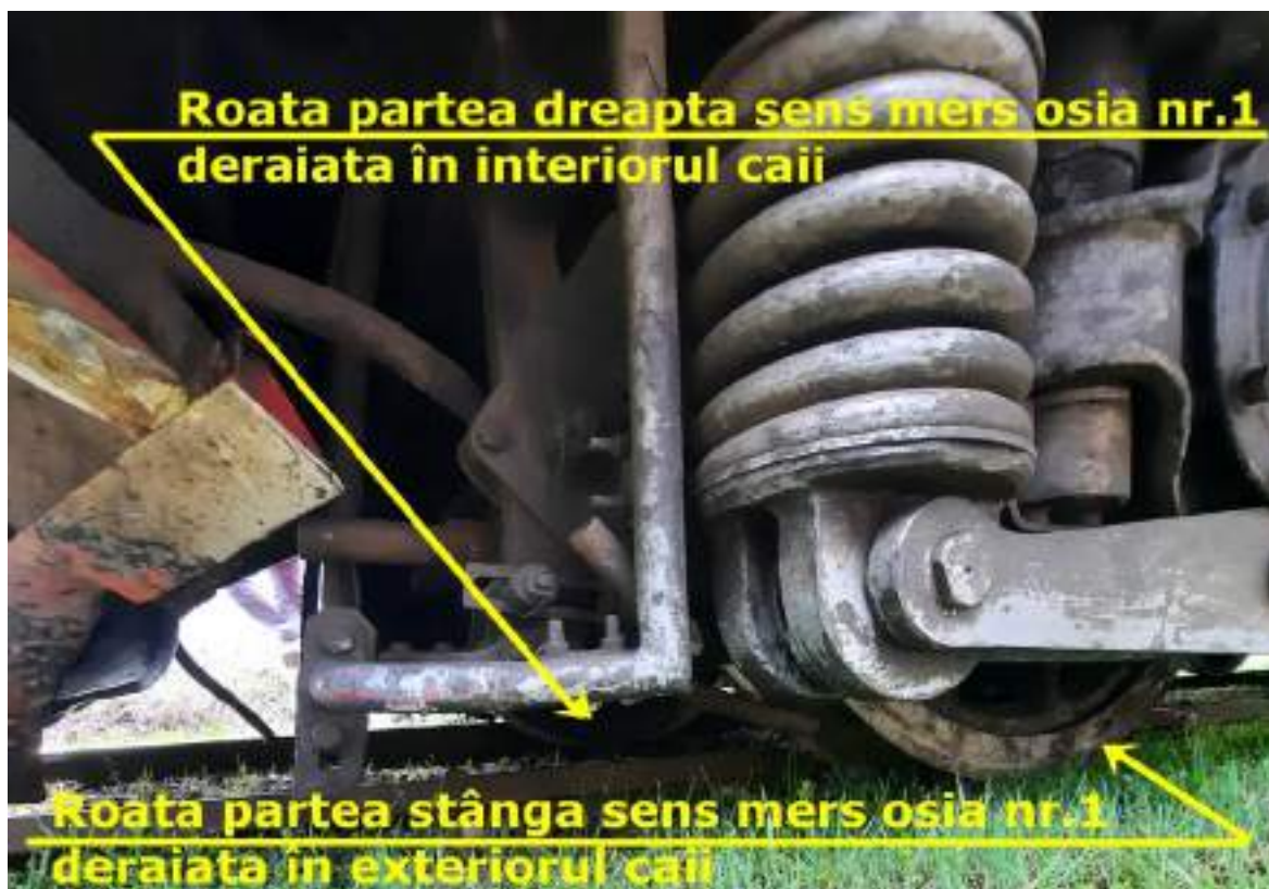
Foto nr.2 Osia nr.1, boghiul nr.1 deraiată
