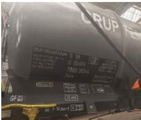
Foto nr.4 - Recipient deformat vagon nr.33537868363-5
