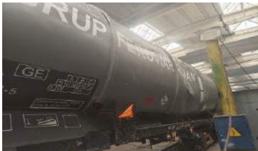
Foto nr.4 - Recipient deformat vagon nr.33537868363-5
