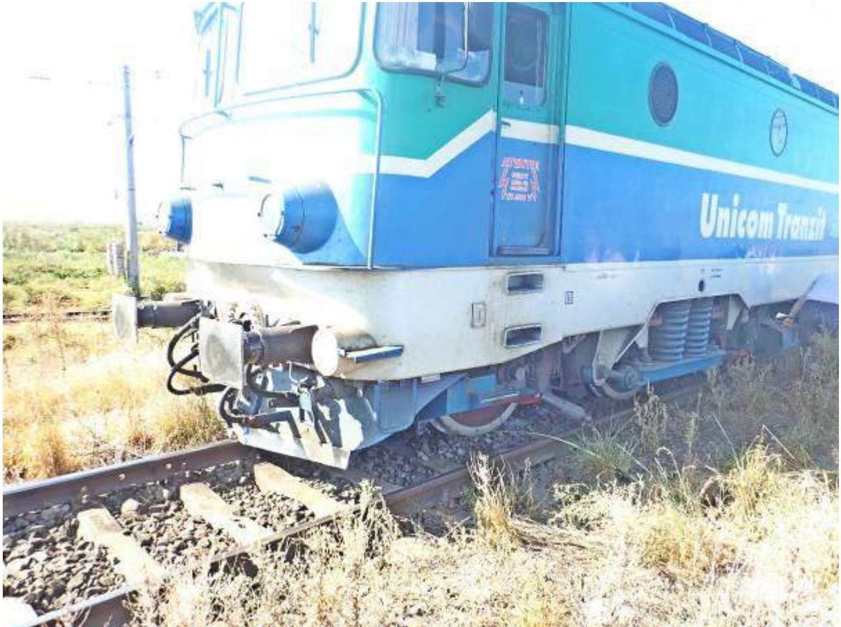
foto nr.1 - poziția locomotivei după deraiere
