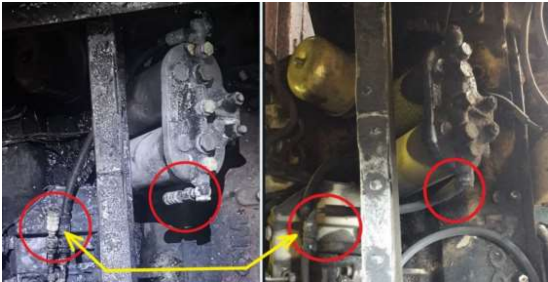
Imaginea nr.13 – diferența între racordul furtunului de intrare în filtru la AMX 533-9 față de racordul original de la AMX 574
