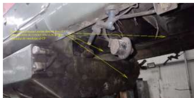
Foto nr.4 – Zona afectată de foc dinspre rezervorul principal de motorină și canalul de ventilație al GP
