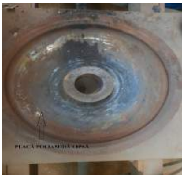
Foto nr.7 crapodină inferioară boghiu C , placă de uzură lipsă
