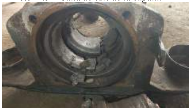
Foto nr.10 - Colivii distruse și dispersate în interiorul cutiei de osie
