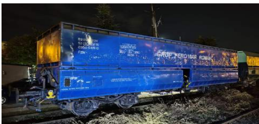
Foto nr.4 - Vagonul nr.89536950046-0 cu ambele boghiuri deraiate revenite pe calea de rulare
