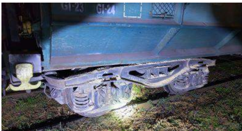
Foto nr.1 și 2 - Vagon nr.31536666192-6 cu boghiul deraiat revenit pe calea de rulare
