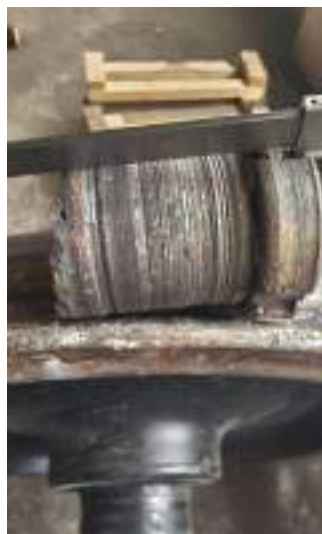
Foto nr.12 - Capăt fus de osie rupt
