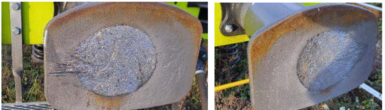
Figura nr.8 - Urme pronunțate de lucru pe talerele tampoanelor din față al celui de-al 4-lea vagon
