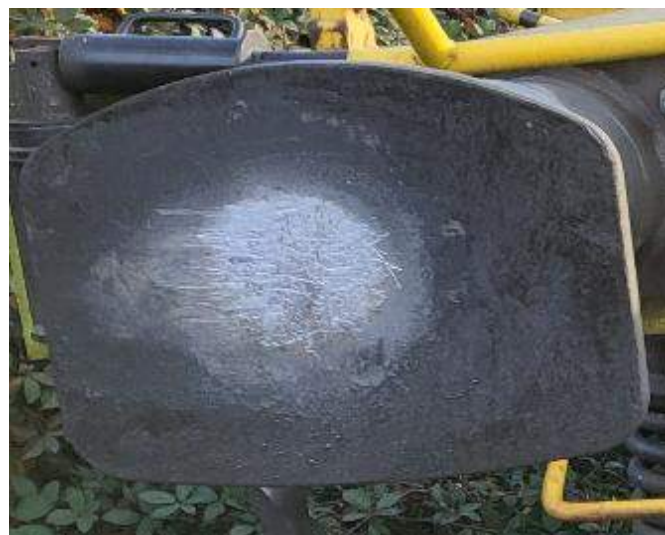
Figura nr.9 - Urme pronunțate de lucru pe talerele tamponelor din spate al celui de-al 5-lea vagon
