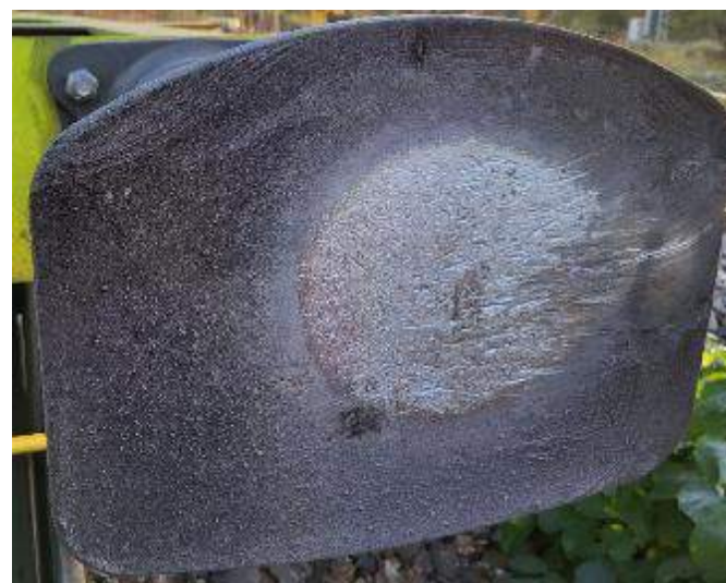
Figura nr.9 - Urme pronunțate de lucru pe talerele tamponelor din spate al celui de-al 5-lea vagon
