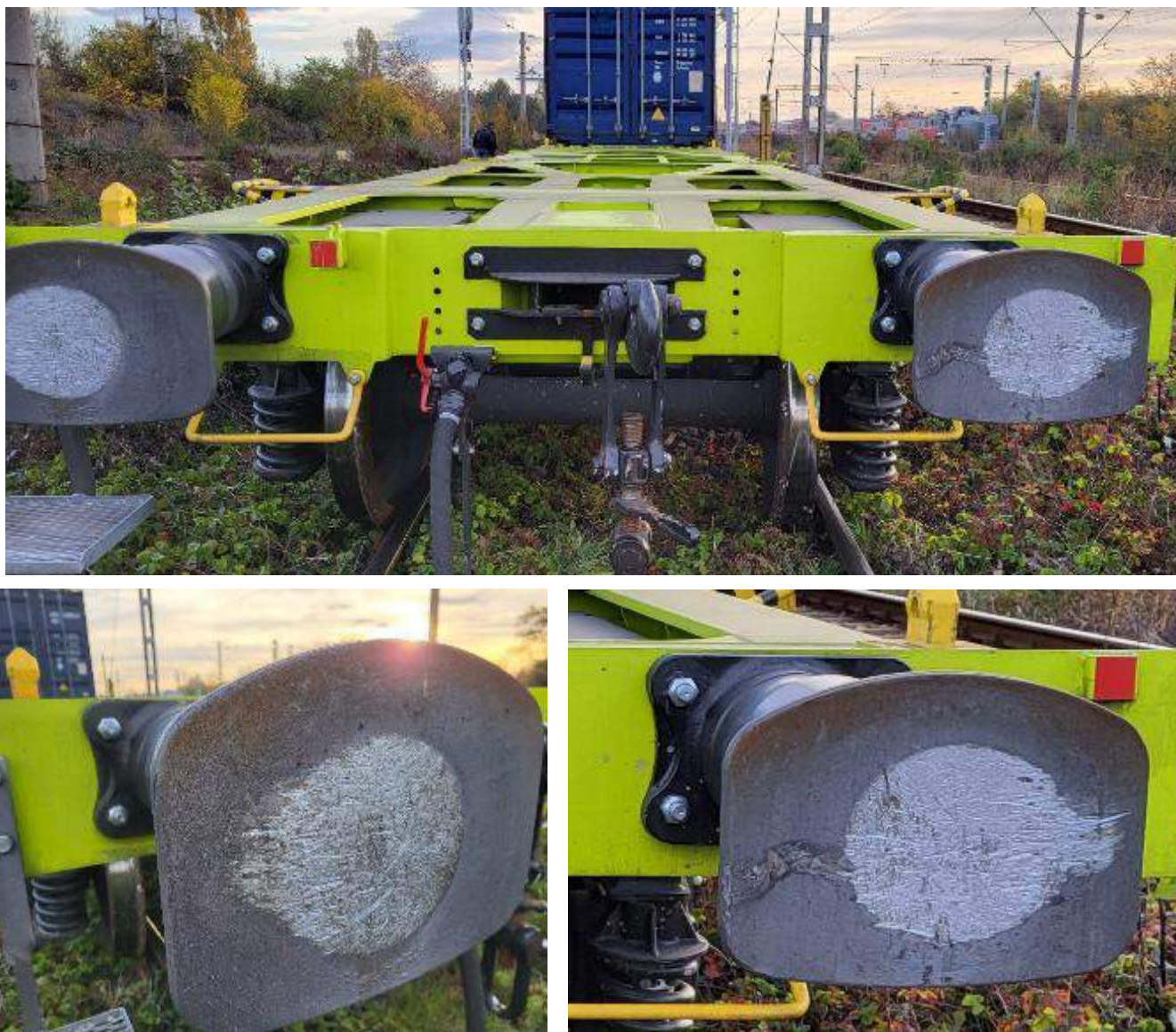
Figura nr.6 Urme pronunțate de lucru pe talerele tamponelor din spate al celui de-al 3-lea vagon
