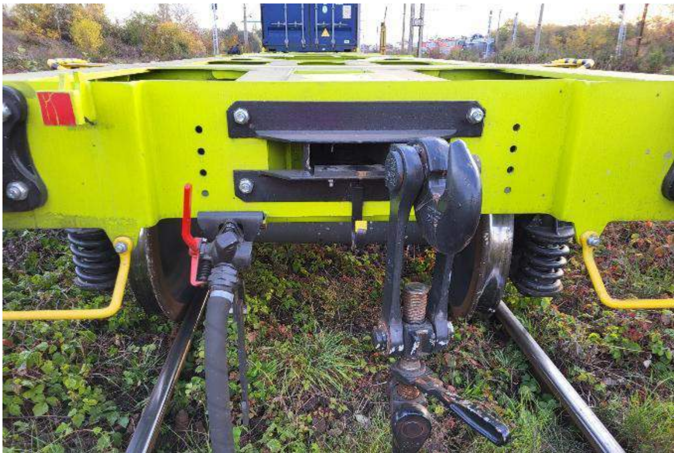
Figura nr.5 - Poziția osiei deraiate de la cel de-al 3-lea vagon
