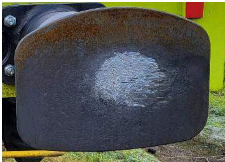
Figura nr.4 - Urme pronunțate de lucru pe talerele tampoanelor din față al celui de-al 6-lea vagon
