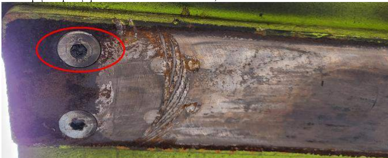
Figura nr.11 - șurubul de fixare (partea exterioară față) al pietrei de frecare superioare, aferentă roților R5-R6
