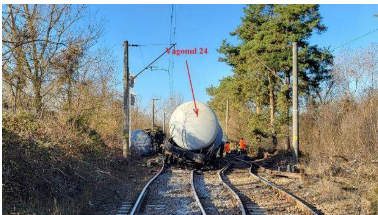
Foto nr.4 – poziția vagonului al 24-lea, după deraiere
