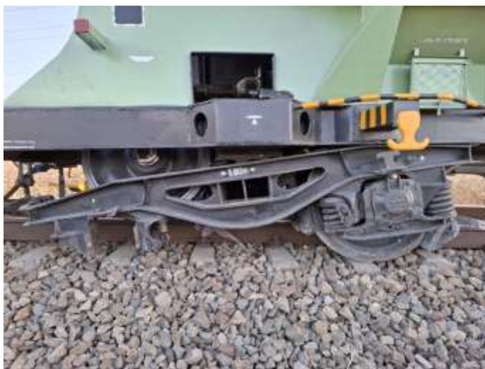
Foto nr.1 - Boghiul deraiat al vagonului nr. 31539333345-7
