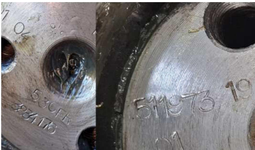
Foto nr. 4 – Marcajele de pe capătul osiei
