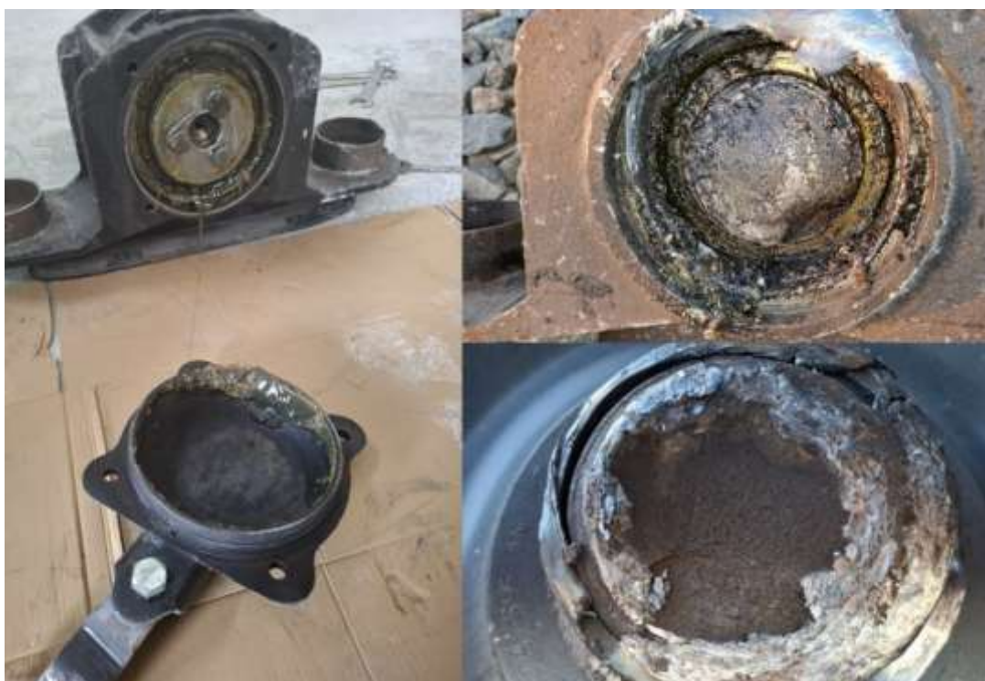
Foto nr.5 - Cutia de osie capăt A cu fusul rupt al osiei nr.3834176
