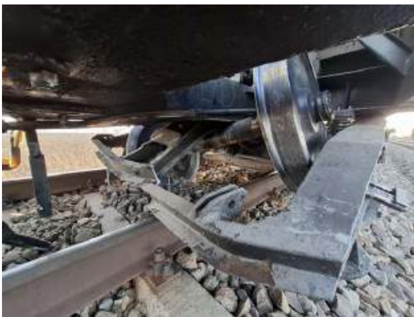
Foto nr.3 – Osia aferentă roților 7-8 după deraiere
