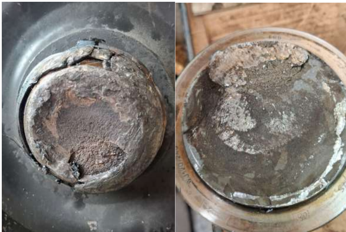
Foto nr. 6 – Aspectul suprafețele de rupere ale fusului rupt de la osia nr.3834176
