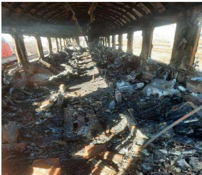
Imaginea nr.5 – interiorul vagonului afectat de incendiu
