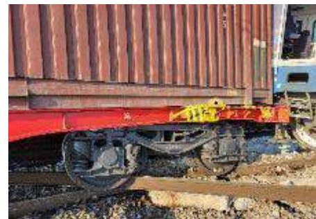
Foto nr.8 – Vagonul de marfă nr.3375952004-3 cu primele 2 boghiuri deraiate
