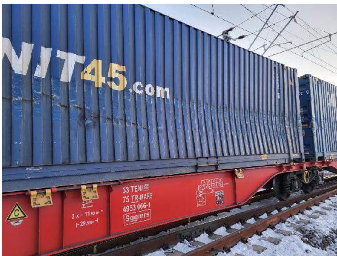
Foto nr.9 – Container lovit încărcat pe vagonul de marfă nr.33754953006-1
