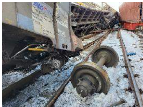
Foto nr.6 – Vagonul de marfă nr.23884371951-5 cu primul semi-vagon avariata având o osie sărită
