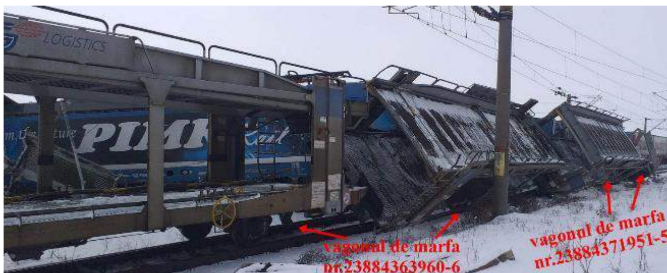
Foto nr.7 – Vagonului de marfă nr.23884363960-6 cu primul semi-vagon deraiat și înclinat
