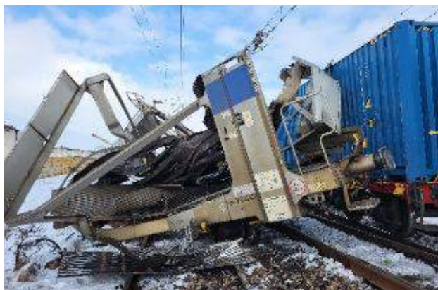
Foto nr.6 – Vagonul de marfă nr.23884371951-5 cu primul semi-vagon avariata având o osie sărită
