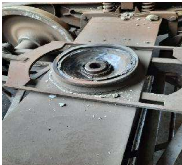
Imaginea nr.3 - Crapodina inferioară de la boghiul deraiat cu placa de poliamidă crăpată și garnitura de etanșare
