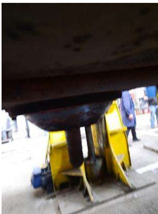
Imaginea nr.11 – crapodina superioară boghiul deraiat Pe partea activă a buzei roții nr.4 s-a constatat existența unei muchii.
