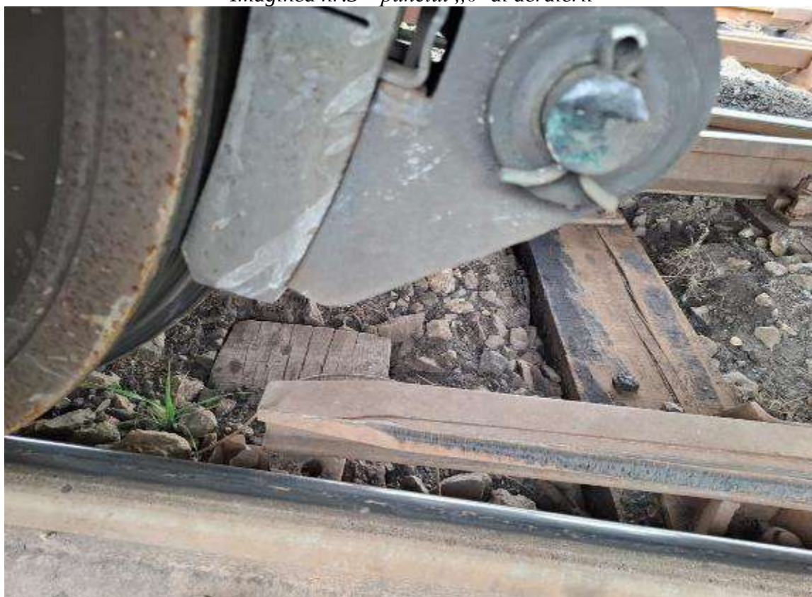
Imaginea nr.4 – escaladarea contrașinei inimii rombului diagonalei 25/33
