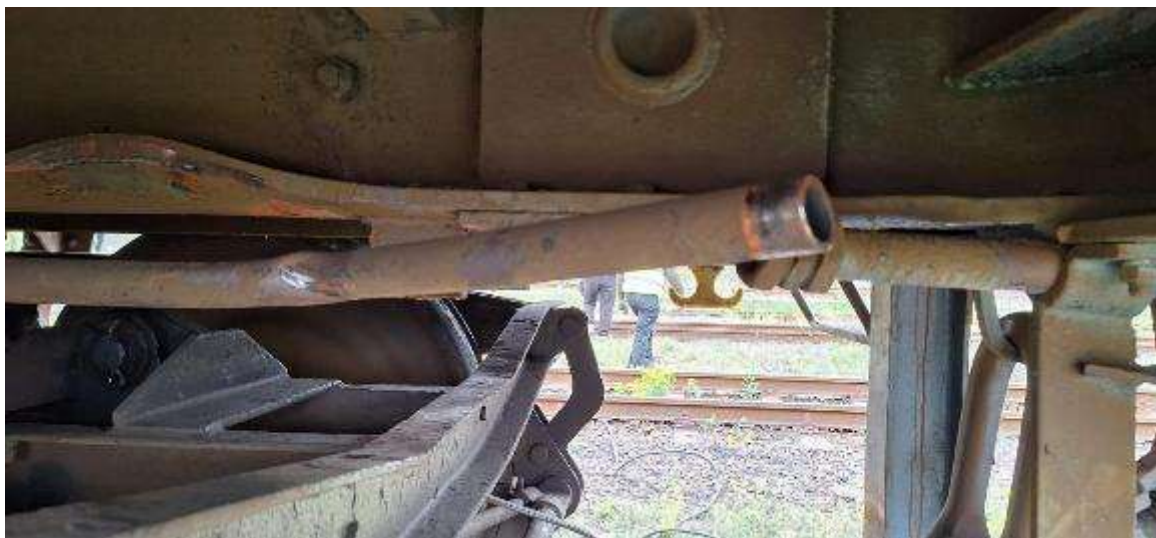
Imaginea nr.9 – deformare locală a longeronului central în zona roții nr.2 (roată găsită pe șină nederaiată) și conducta generală de aer deformată și smulsă din mufa de prindere în două locuri
