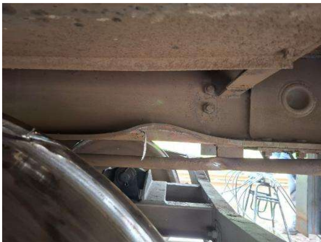
Imaginea nr.8 – urme pronunțate de lovire pe buza roții nr.2 (roată găsită pe șină nederaiată)
