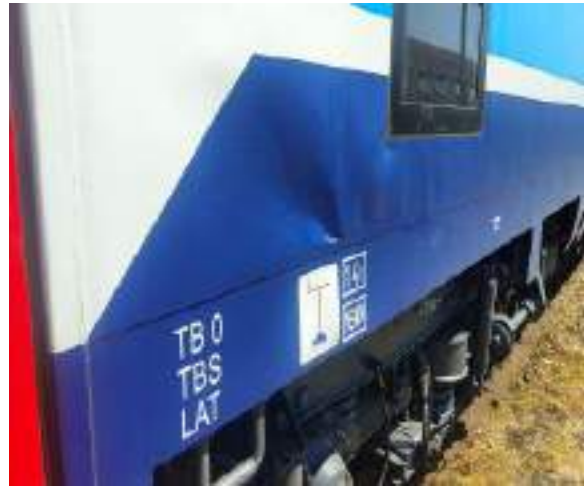
Foto nr.9 – Perete lateral deformat
