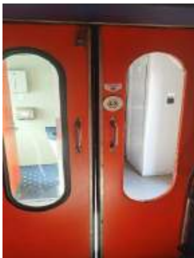
Foto nr.2 – Geam ușă căzut
