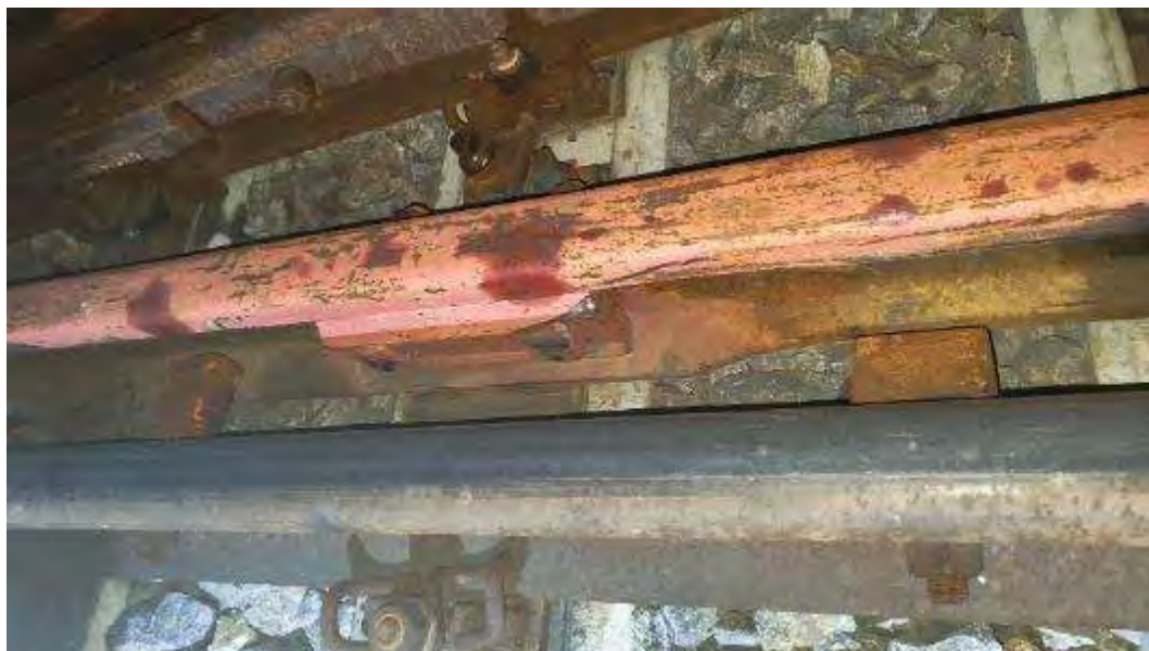
Foto. nr.10 – Urmă de lovire pe suprafața aripii acului drept din partea stângă a aparatului de cale
