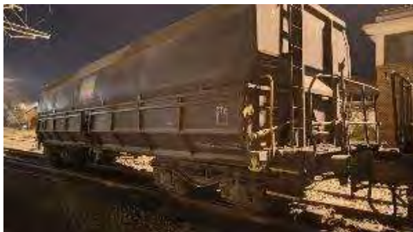
Foto nr.1 - Primul boghiu (roțile 5÷8) deraiat în sensul de mers pe schimbătorul de cale nr.74
