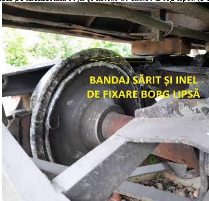
Foto nr.3 – R8 – bandaj sărit și inel de fixare lipsă;
