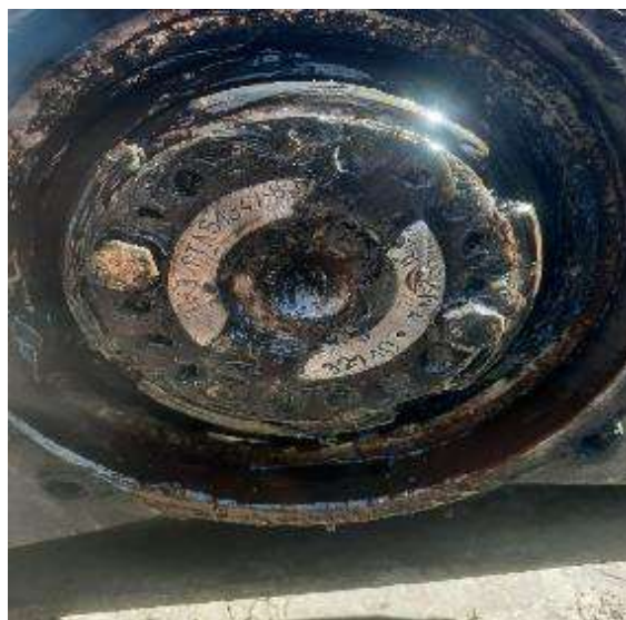
Foto nr.9 și nr.10. – marcajul pe ambele fusuri de osie ale roților 7-8;
