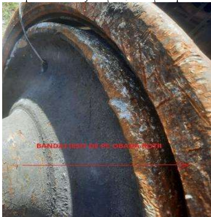
Foto nr.11 – bandajul ieșit de pe membrană al roții nr.8;
