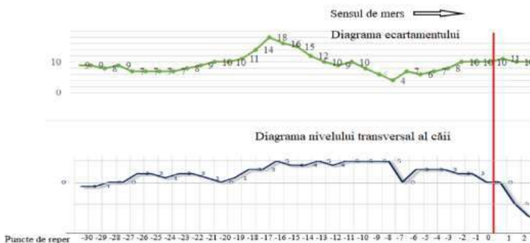
Figura nr.6 - valorilor măsurate ale ecartamentului și nivelului transversal
