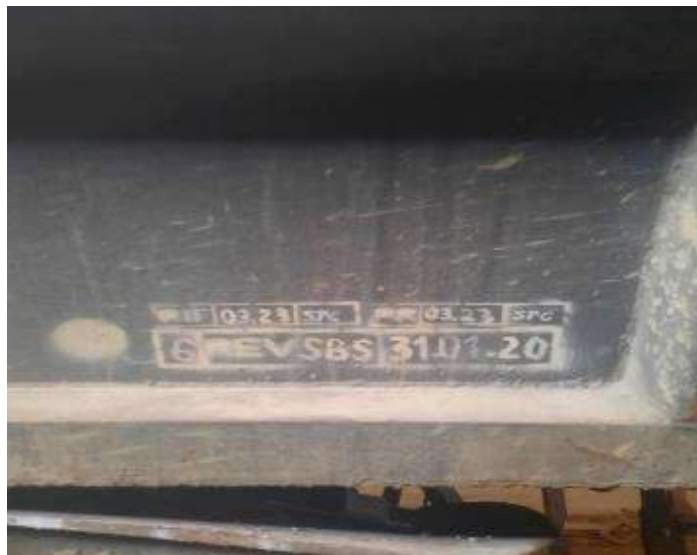
Foto nr.2 – cartuş de mentenanță al vagonului nr. 81536652446-1cu revizia periodică și reviziile intermediare (RP, RRu, RIF) ;
