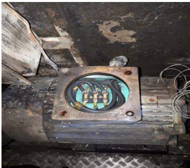
Foto nr.7. Cablurile electrice ale motorului compresorului neafectate.
