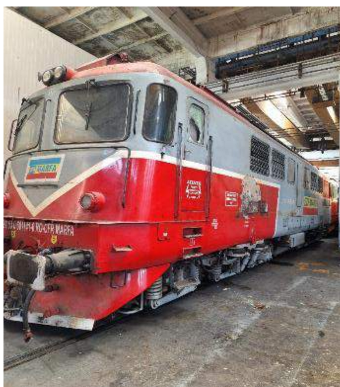
Foto nr.4 Locomotiva DA1141 cu afectarea termică în exterior în Depoul CFR Craiova
