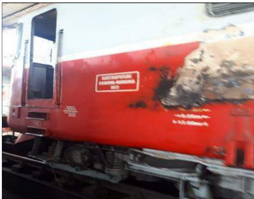
Foto nr.1.Locomotiva DA1141cu afectarea termică în exterior în zona bateriilor de acumulatori nr.11și nr.12.
