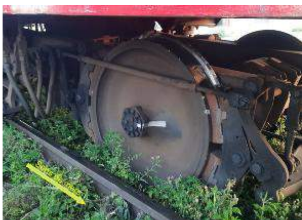
Foto nr.3 – Osia nr.6 deraiată
