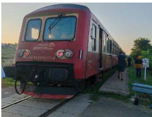
Foto nr.2 – Automotorului AMX 571 deraiat
