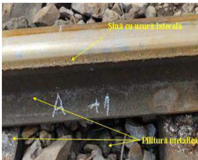
Foto.nr.9 – Șină uzată cu pilitură pe talpa șinei
