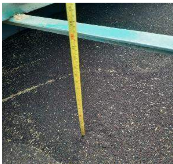
Foto nr.8 - Zona cu gol la încărcătură vagon, în compartimentul 3
