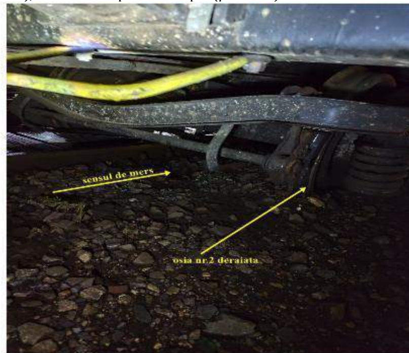
Foto nr.1 – Osia nr.2 - vagonul nr.33849345020-3
