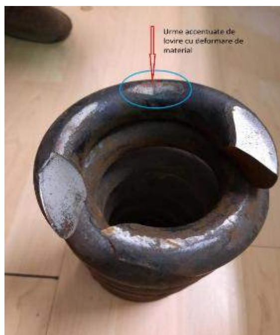
Foto nr.13 - Arc de suspensie cu ruptură nouă la roata corespondentă nr.3L
