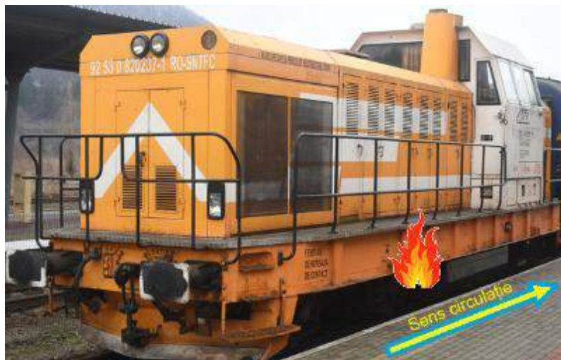
Foto nr.1 – Localizarea incendiului la locomotiva DHC 190
