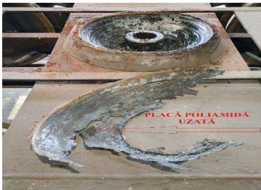
Foto nr.4 – crapodină boghiul cu osiile 1-2, placa de poliamidă uzată
