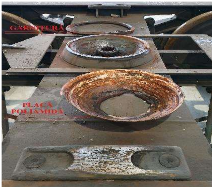
Foto nr.5 – crapodină boghiul cu osiile 3-4, placa de poliamidă și garnitura de etanșare
