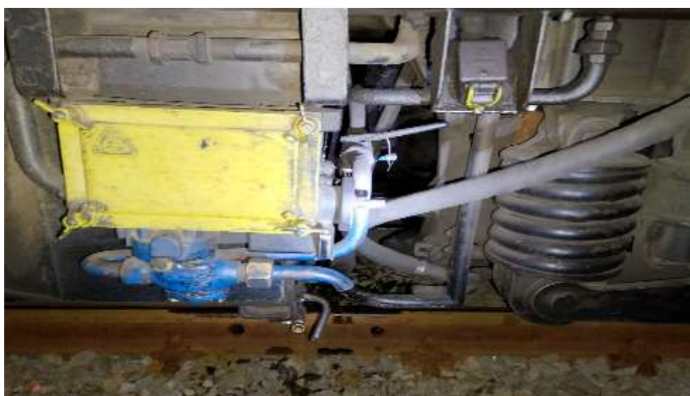
Foto nr.2: robinet izolare DSV în poziția închis
