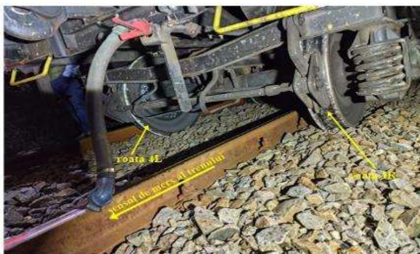
Foto nr.1: Osia nr.4 deraiată
