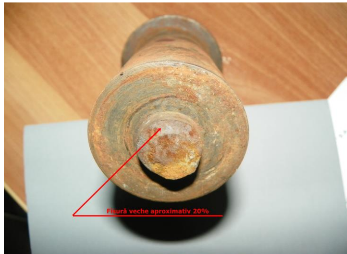
Imaginea 14 – bulonul (bolțul) de la timoneria de frână al locomotivei EA 314, rupt la data de 29.11.2015 (extras din Raportul de investigare)
