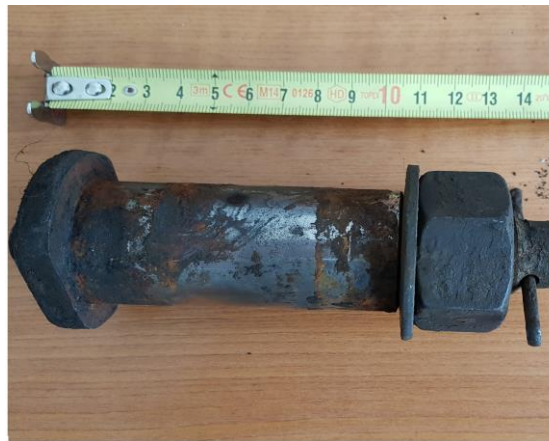
Imaginea 10 – bolt, șplint, piuliță și șaibă montate la capul barei de frână (reconstituire)
