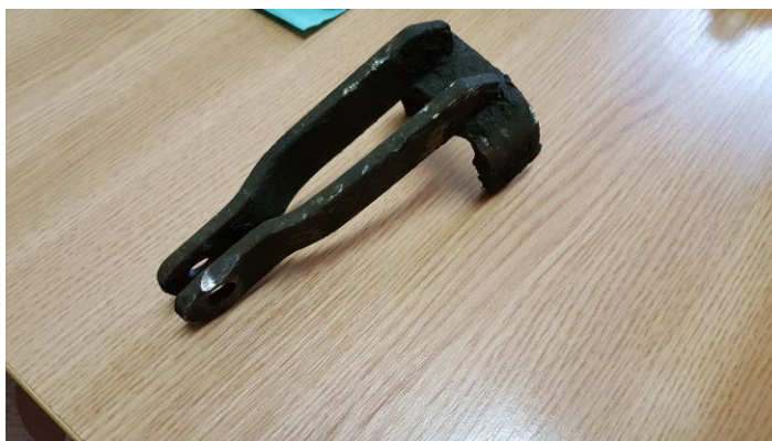
Imaginea 8 – piesă metalică desprinsă de la bara de frână, a locomotivei DA 1356
