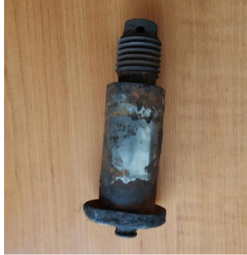
Imaginea 13 – bolțul de la capul barei de frână al locomotivei DA1356 (reconstituire)
