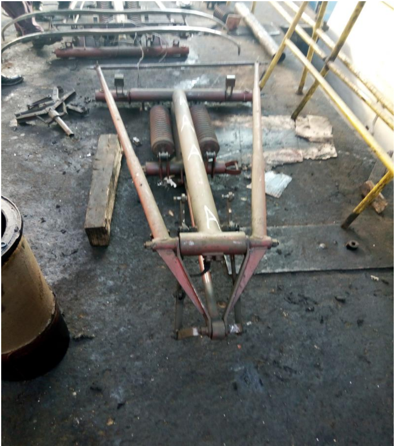
Foto nr.2 – Pantografele de la locomotiva EC126 (fără deformări ale cadrelor, cu izolatorii de susținere secționati)
