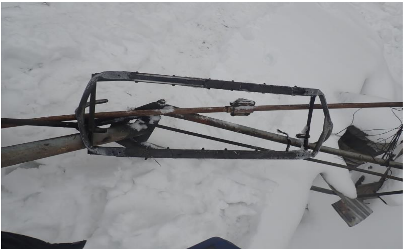
Foto nr.10 - Pantograful tip EP3 avariata al locomotivei EA305
