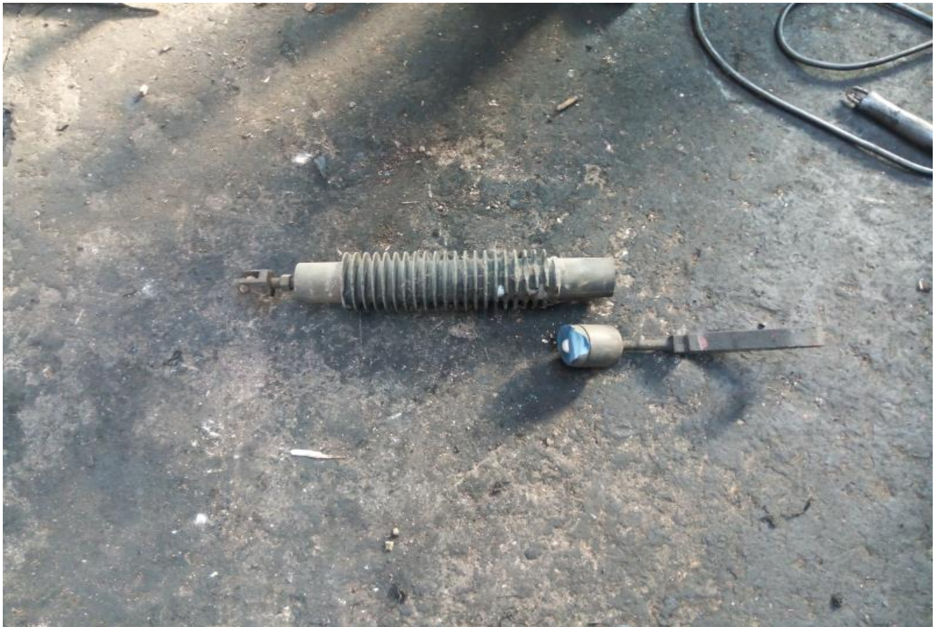
Foto nr.6 - Izolator tracțiune rupt de la cilindrul de acțiune al pantografului de la postul de conducere „B” (din față, inactiv)
