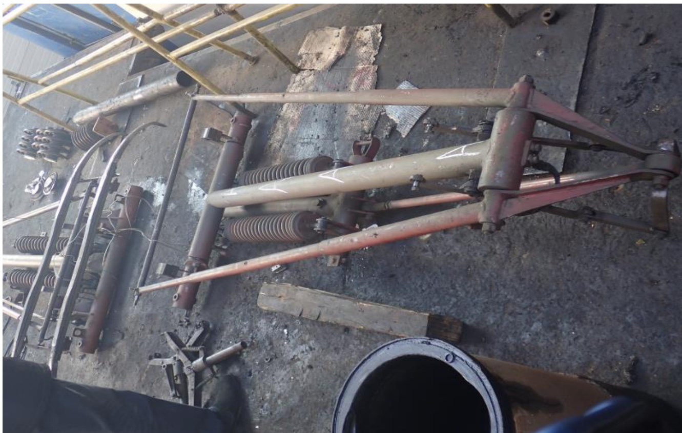
Foto nr.8 - Cadre pantografe „A” și „B” ale locomotivei EC126 fără deformări, loviri sau urme de flamare
