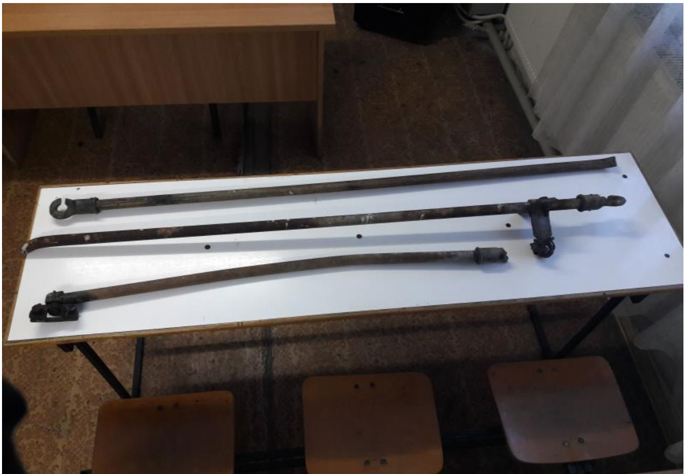
Foto nr.15 – Fixătoare (avariate) de susținere și asigurare a geometriei firului liniei de contact
