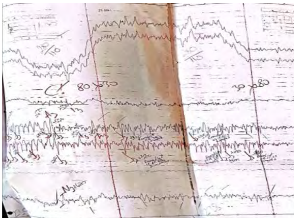
Foto nr.19 – Diagrama înregistrată pe banda VMC la verificarea liniei efectuată la data de 25.09.2023 pe curba km.237+600 ÷ 238+410
