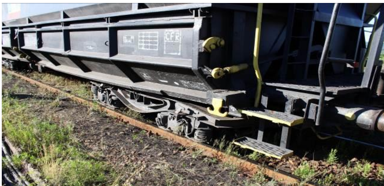
foto 2: poziția vagonului aflat al 39-lea în compunerea trenului, după deraiere
