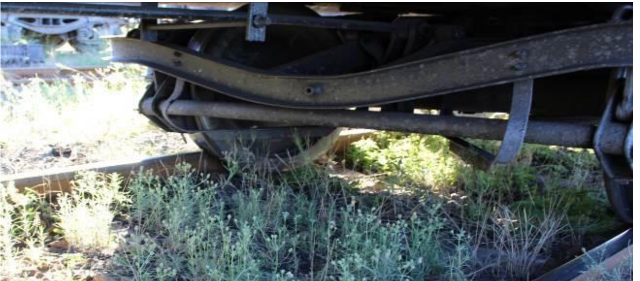
foto 4: poziția roții nr.5 a vagonului aflat al 40-lea în compunerea trenului, după deraiere
