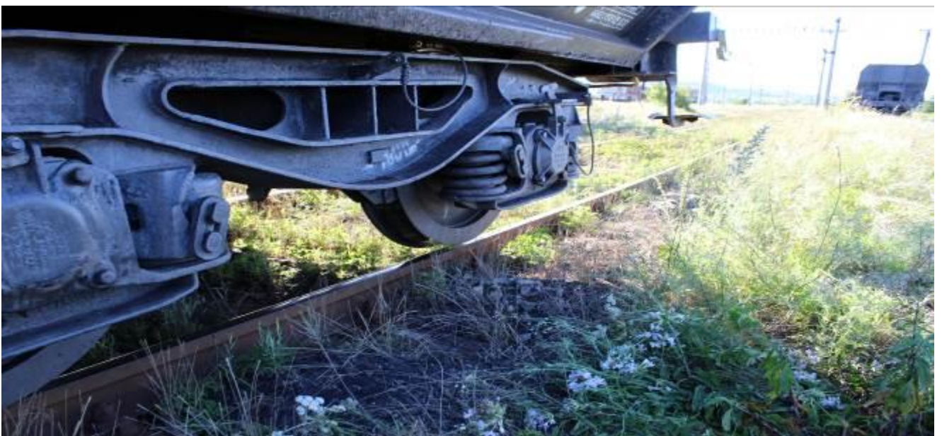
foto 5: poziția roții nr.8 a vagonului aflat al 40-lea în din compunerea trenului, după deraiere
