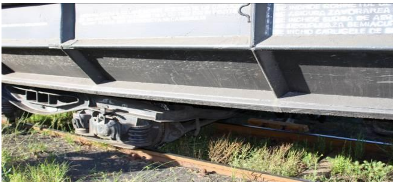
foto 1 - poziția vagonului aflat al 37-lea în compunerea trenului, după deraiere
