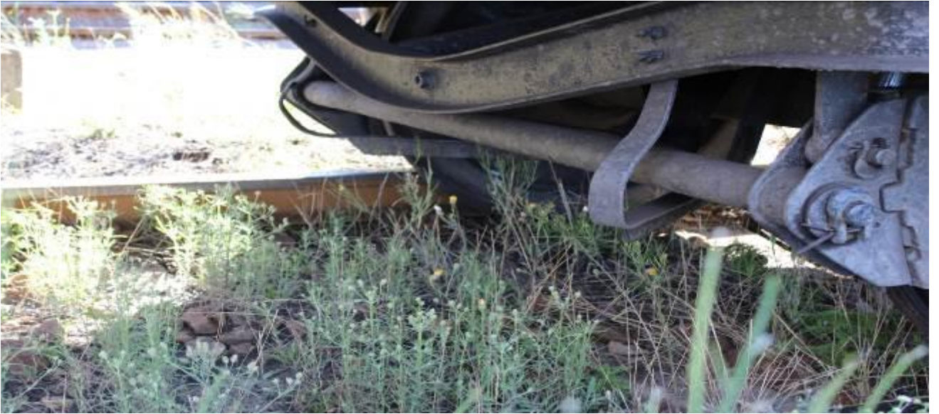
foto 3: poziția roții nr.1 a vagonului aflat al 40-lea în din compunerea trenului, după deraiere
