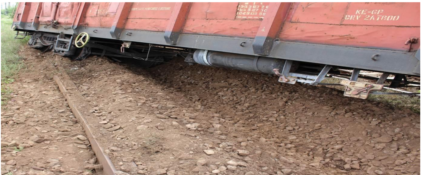
foto 3: poziția boghiului I al vagonului aflat al 17-lea în componerea trenului, după deraiere
