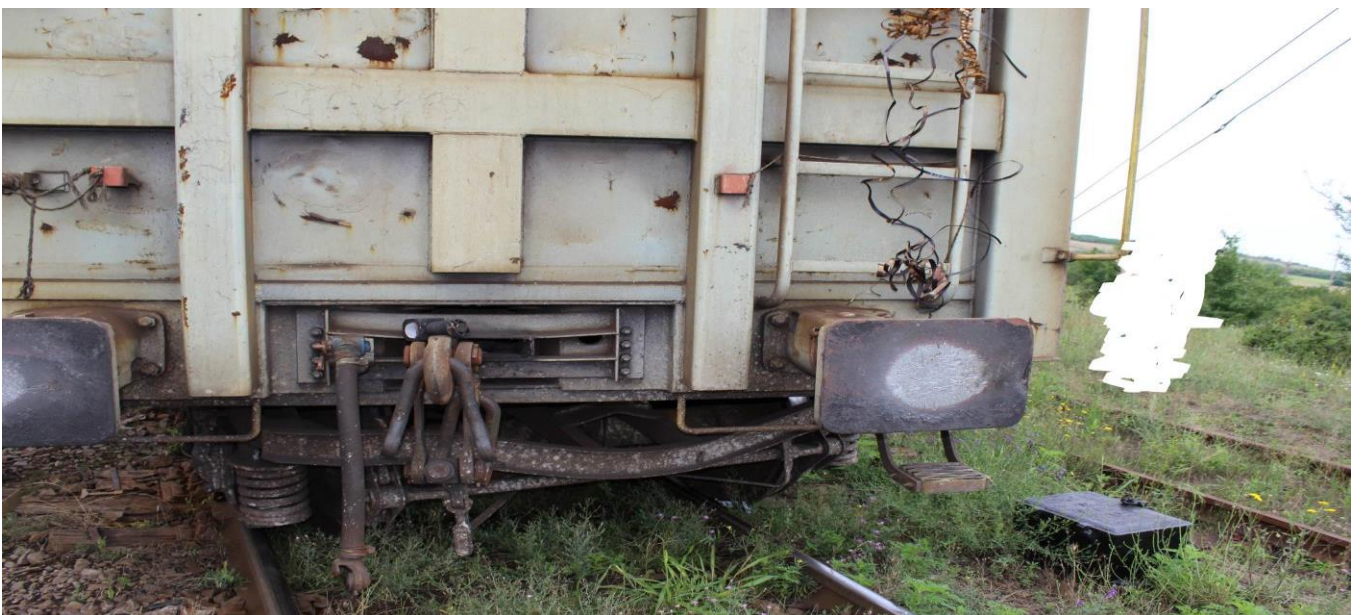
foto 1: poziția boghiului I al vagonului aflat al 16-lea în compunerea trenului, după deraiere
