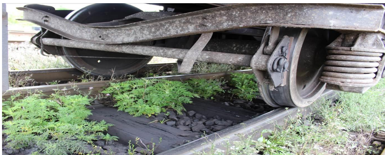
foto 6: poziția boghiului I al vagonului aflat al 25-lea în compunerea trenului, după deraiere
