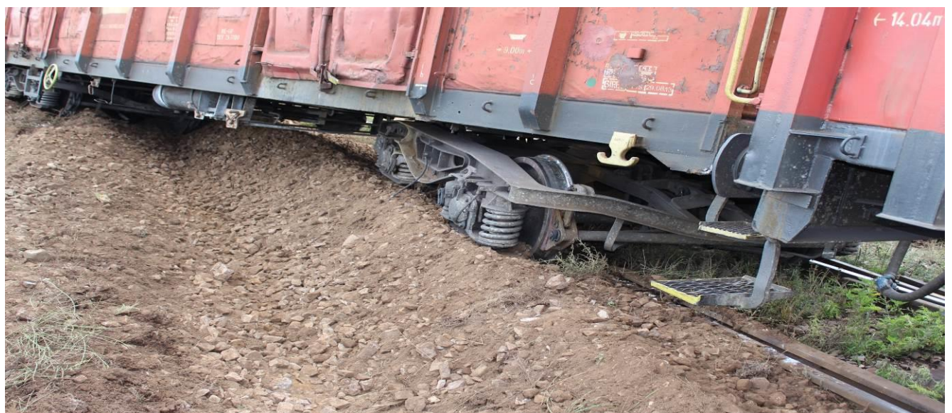
foto 4: poziția boghiului II al vagonului aflat al 17-lea în componerea trenului, după deraiere
