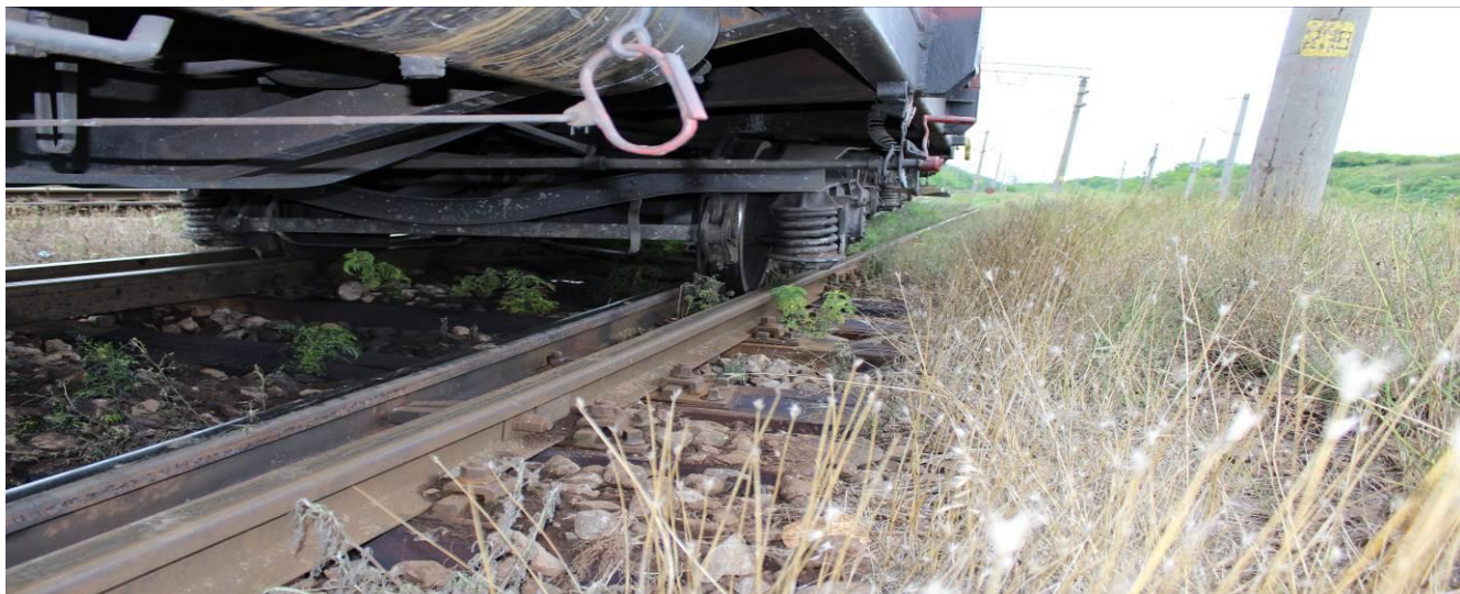
foto 5: poziția boghiului II al vagonului aflat al 24-lea în compunerea trenului, după deraiere
