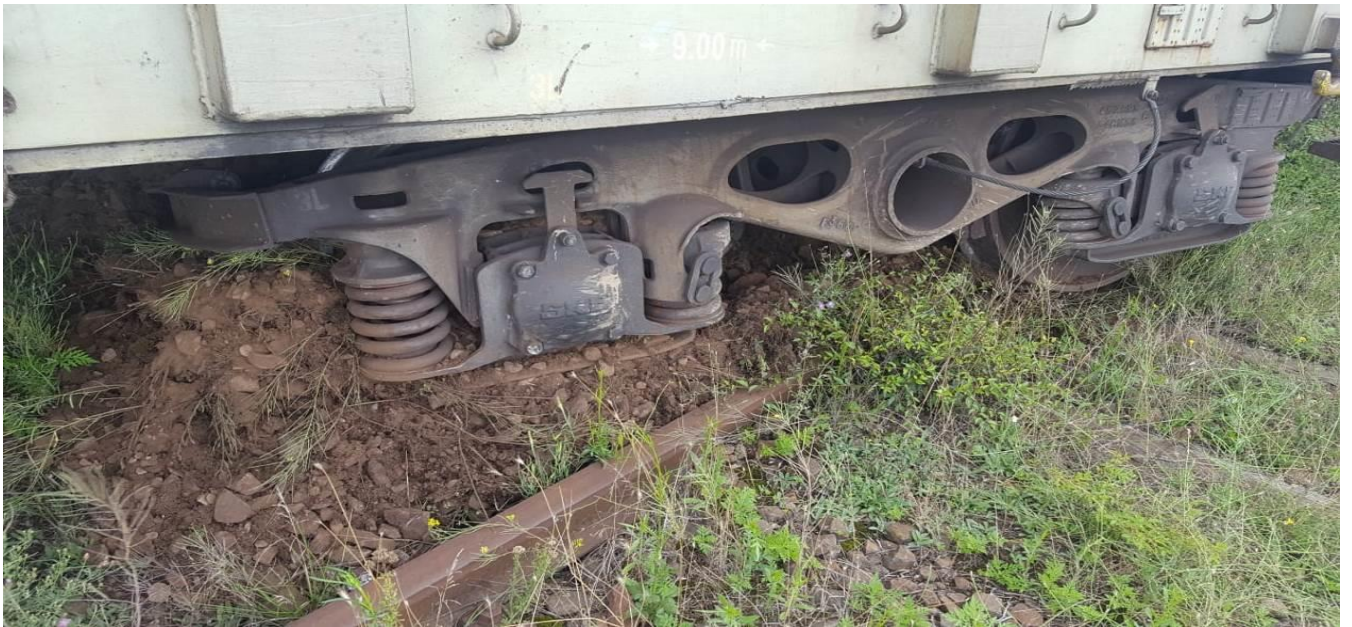
foto 2: poziția boghiului II al vagonului aflat al 16-lea în componerea trenului, după deraiere
