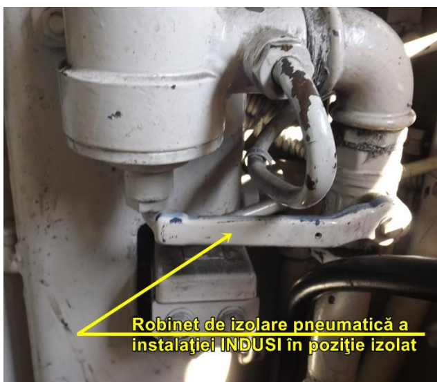
Foto nr.23 - robinet de izolare pneumatică izolat
