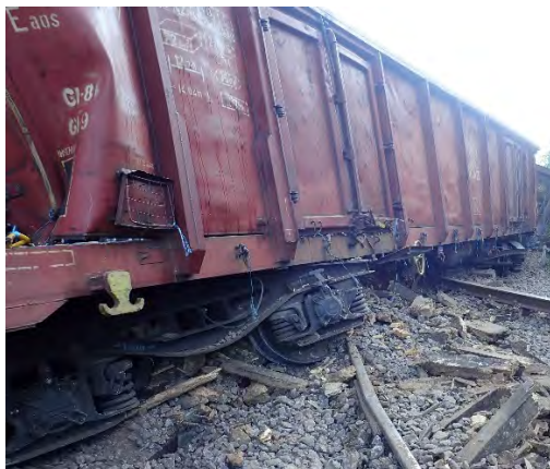
Fotografia nr.2 – vagonul nr.84535304255-7 după deraiere
