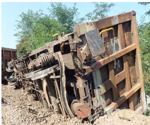
Fotografia nr.3 – vagonul nr.33876735717-5 după deraiere
