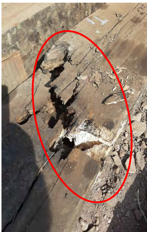
Fotografia nr.25 - Punerea în evidență a planului de rupere ca urmare a solicitării la compresiune (strivire) a traversei T 1 în zona de reazem (traversă situată pe zona neafectată de deraiere) la care rezistențele mecanice au fost afectate de către zonele de putregai existente la interiorul traversei, în nucleul materialului lemnos.
