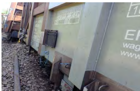
Fotografia nr.10 – vagonul nr.33876735361-2 după deraiere
