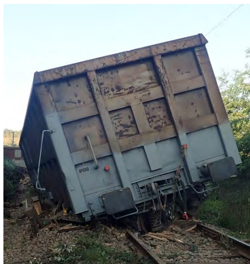
Fotografia nr.1 – vagonul nr.33876735251-5 după deraiere
