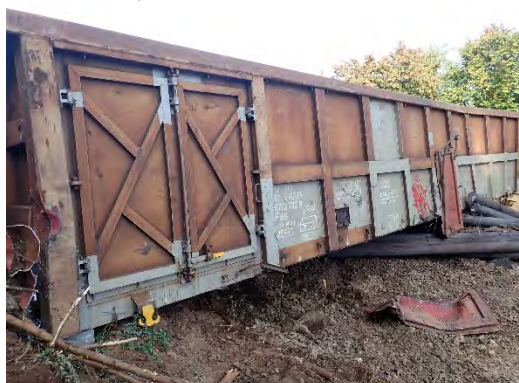
Fotografia nr.7 – vagonul nr.33876735782-9 după deraiere
