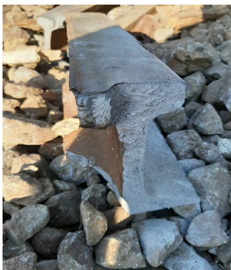
Fotografia nr.22 Capăt de șină rupt - consecință a producerii accidentului feroviar
