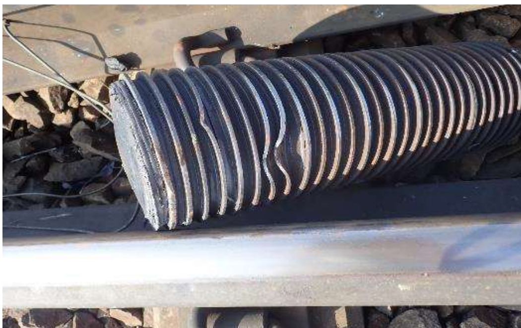
FOTO nr.5, elementul elastic de amortizare a aparatului de ciocnire
