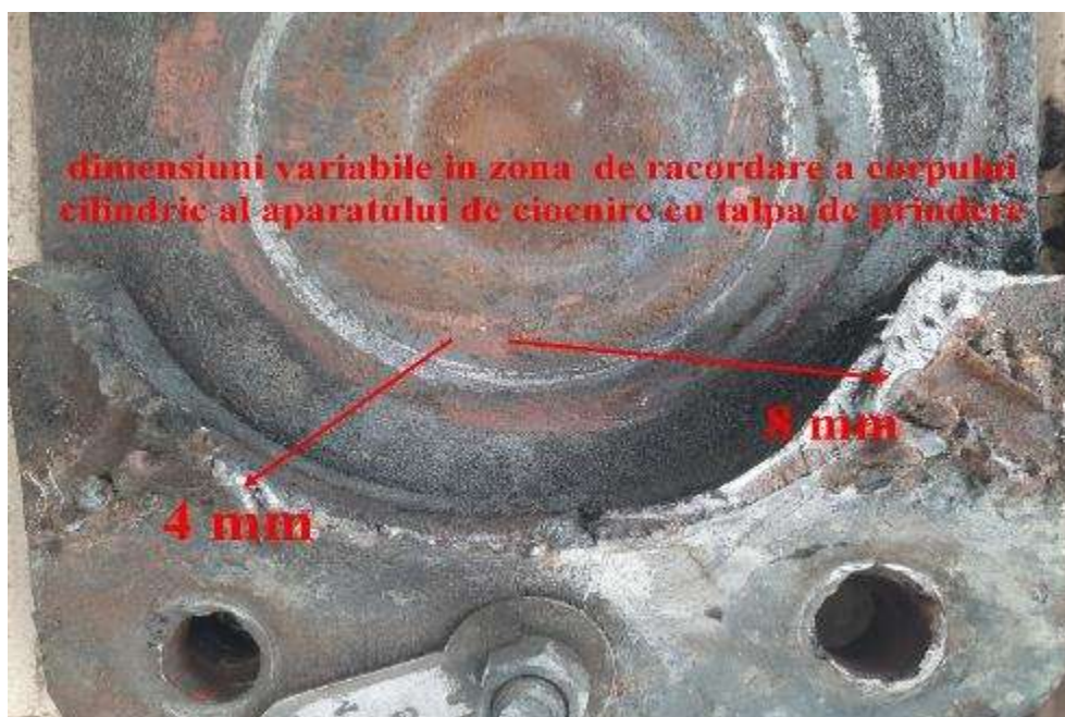
FOTO nr.4, dimensiuni variabile în grosime, de 8 mm la partea inferioară și de 4 mm la partea superioară, în zona de racordare cu talpa aparatului de ciocnire;
