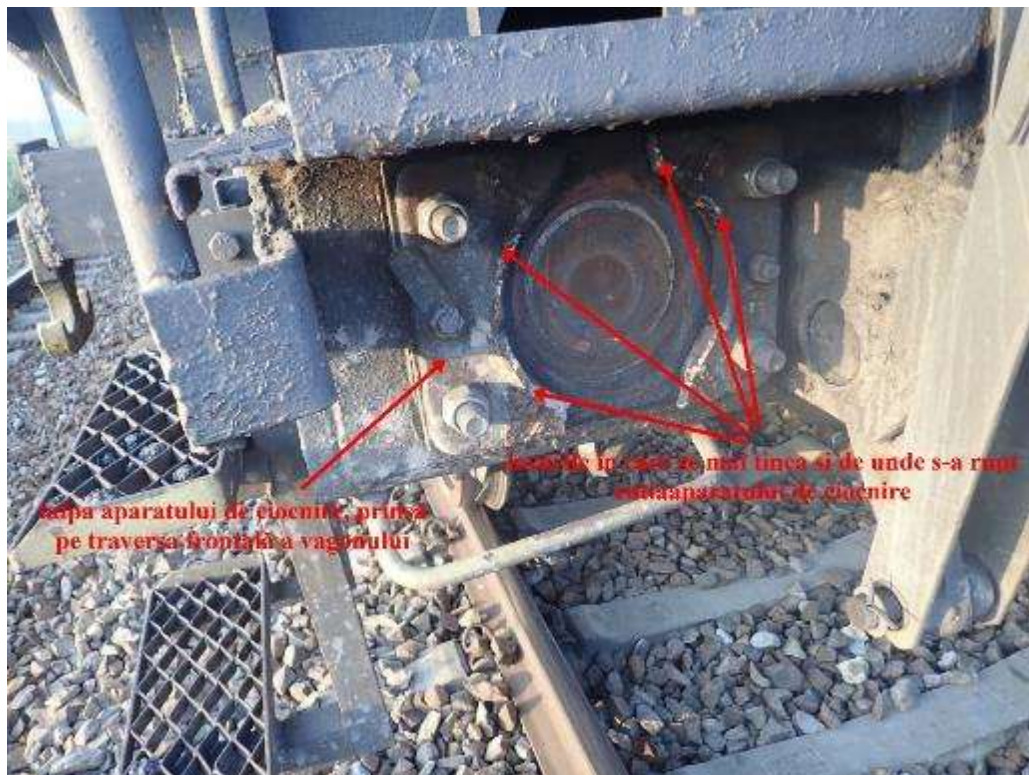
FOTO nr.2, talpa aparatului de ciocnire, montată pe traversa frontală a vagonului și locurile de unde s-a rupt cutia aparatului de ciocnire
