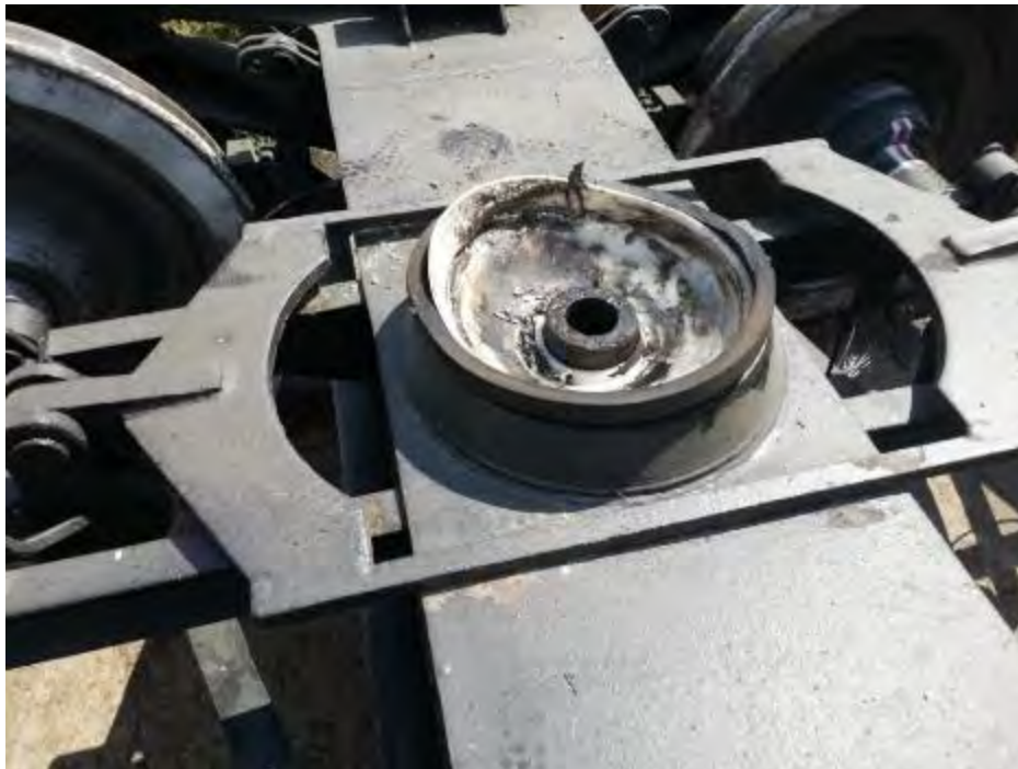
Fotografia nr.7 - Crapodina inferioară a boghiului deraiat
