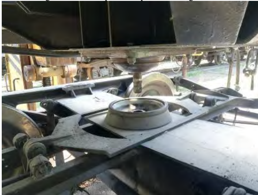
Fotografia nr.8 - Crapodina superioară a boghiului deraiat
