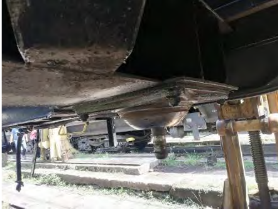
Fotografia nr.8 - Crapodina superioară a boghiului deraiat
