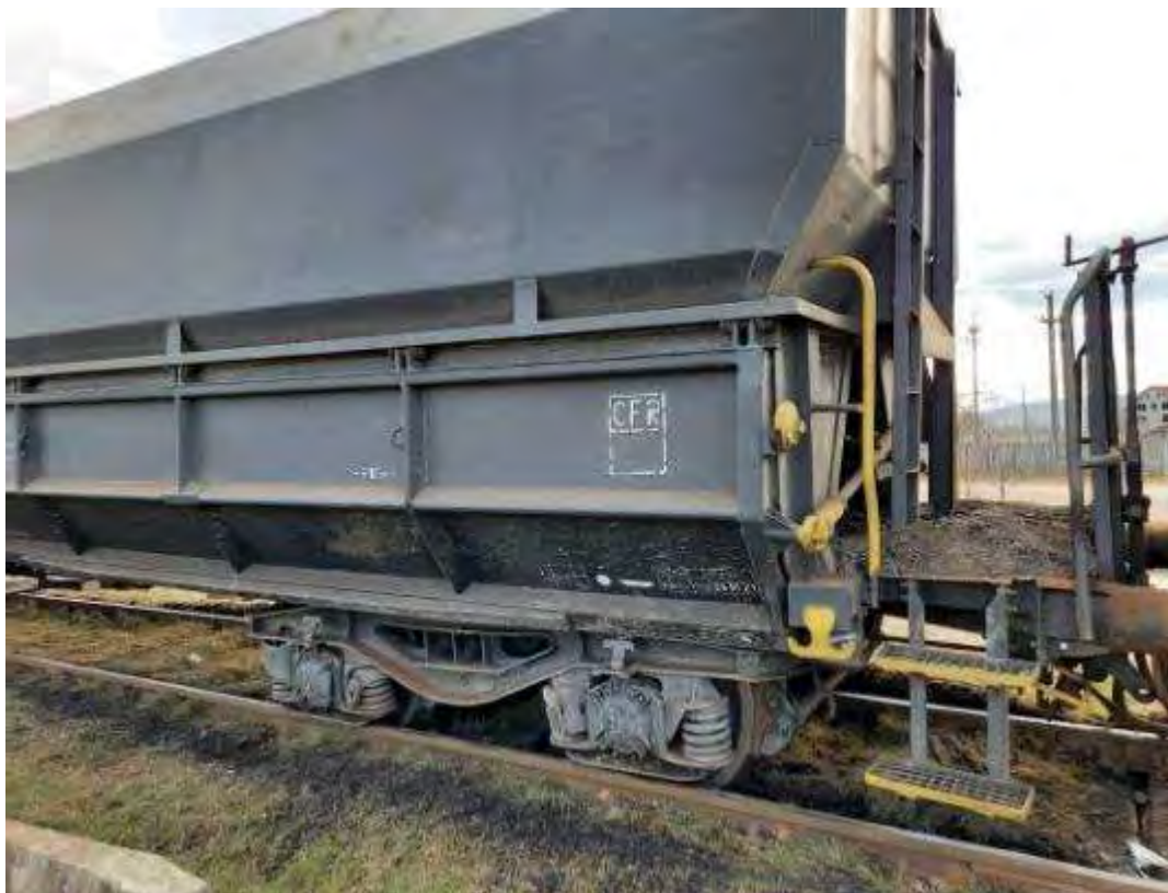
Foto nr.4 : vagonul al 15–lea de la siguranță, nr 81536651226-8, în stare deraiată
