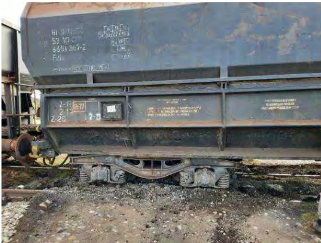
Foto nr.5: vagonul al 16-lea de la siguranță nr.81536651347-2 în stare deraiată
