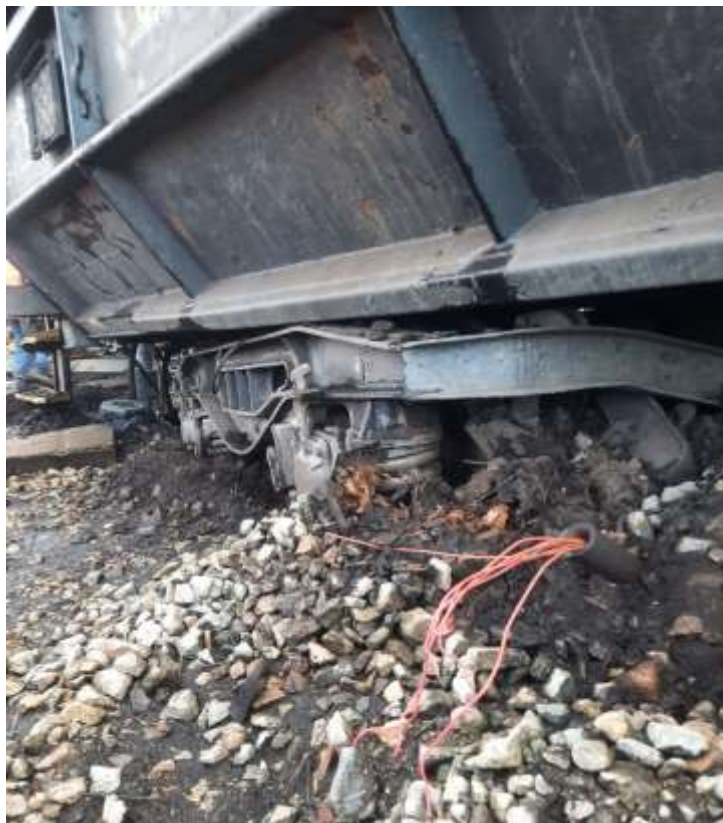
Foto nr.3: vagon în stare deraiată
