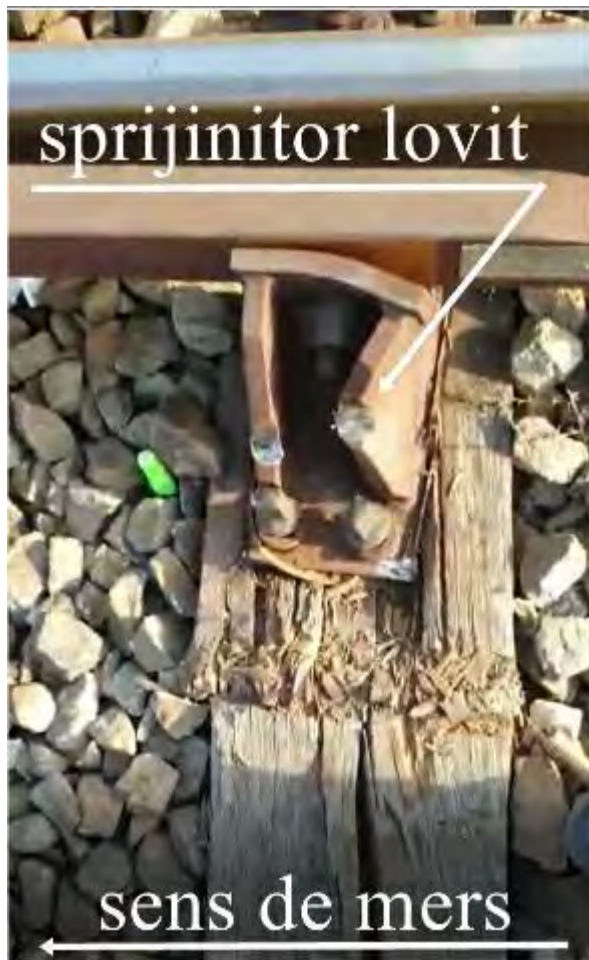
Foto nr.1 – primul sprijinitor al contrașinei din dreapta, în sensul de mers al trenului
