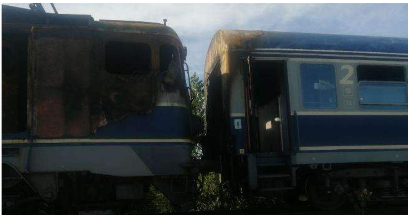
Foto nr.5 – capătul vagonului nr.50 53 22-96 024-4, afectat de incendiul produs la locomotiva EA 889
