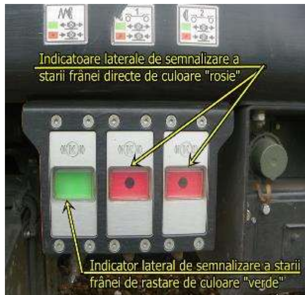
Foto nr.8 Indicator pentru starea frânelor pneumatice
