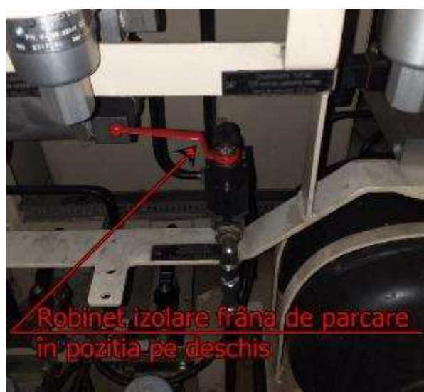
Foto nr.10 Robinet izolare frână de parcare
