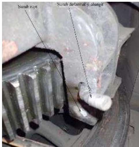
Foto nr.6 Partea superioară a tobei de angrenaj nr.5, partea dinspre osia nr.6
