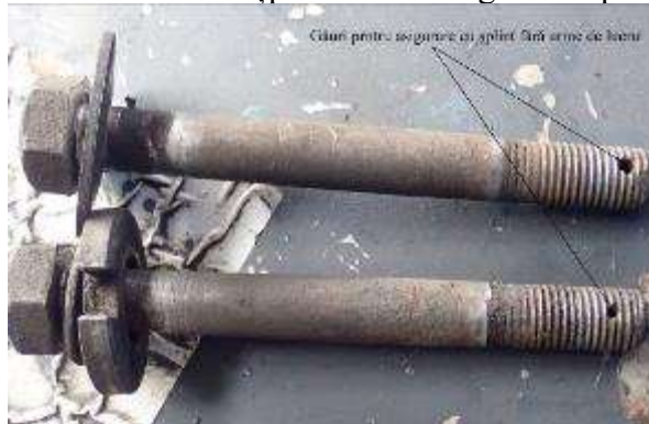
Foto nr.5 Șuruburile de M18 cu urme de lucru pe zona filetată și fără urme de lucru (cu impurități) în găurile de montare a șplintului de asigurare a piuliței
